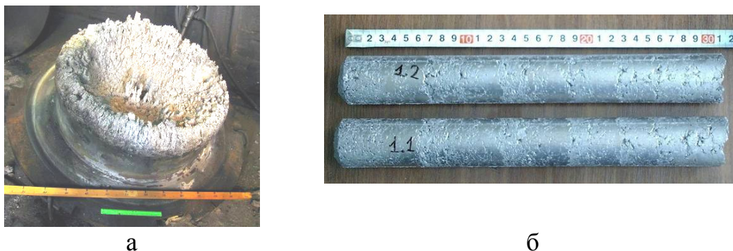
Рис. 1. Реакционная масса на крышке аппарата магнийтермического восстановления (а) и отпрессованные из неё блоки для расходоуемого электрода (б)
