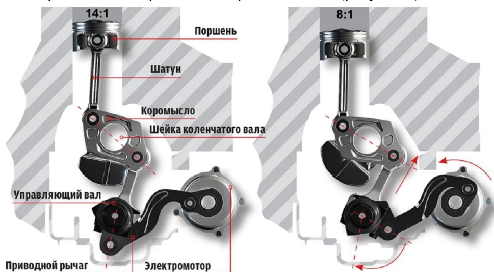
Рисунок 5 – Механизм изменения степени сжатия в двигателе VC-Turbo
