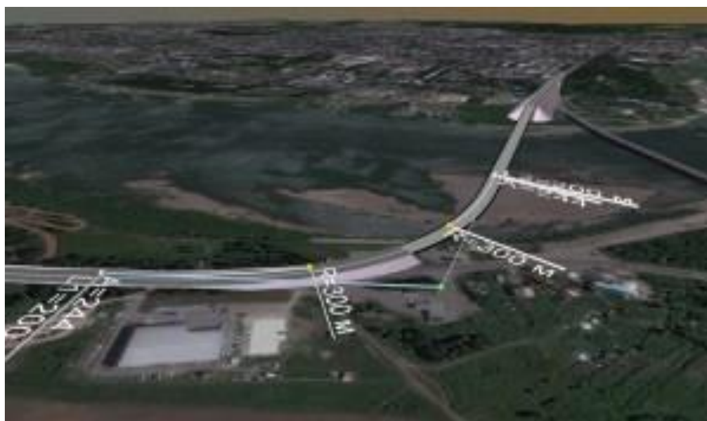
Рисунок 3.1 – Концептуальная модель дороги на этапе планирования в IndorCAD 10
