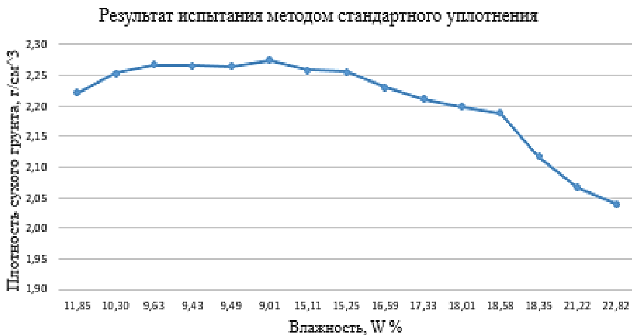
Рисунок Б.1 – Графический результат испытания грунта с ферментом методом стандартного уплотнения
