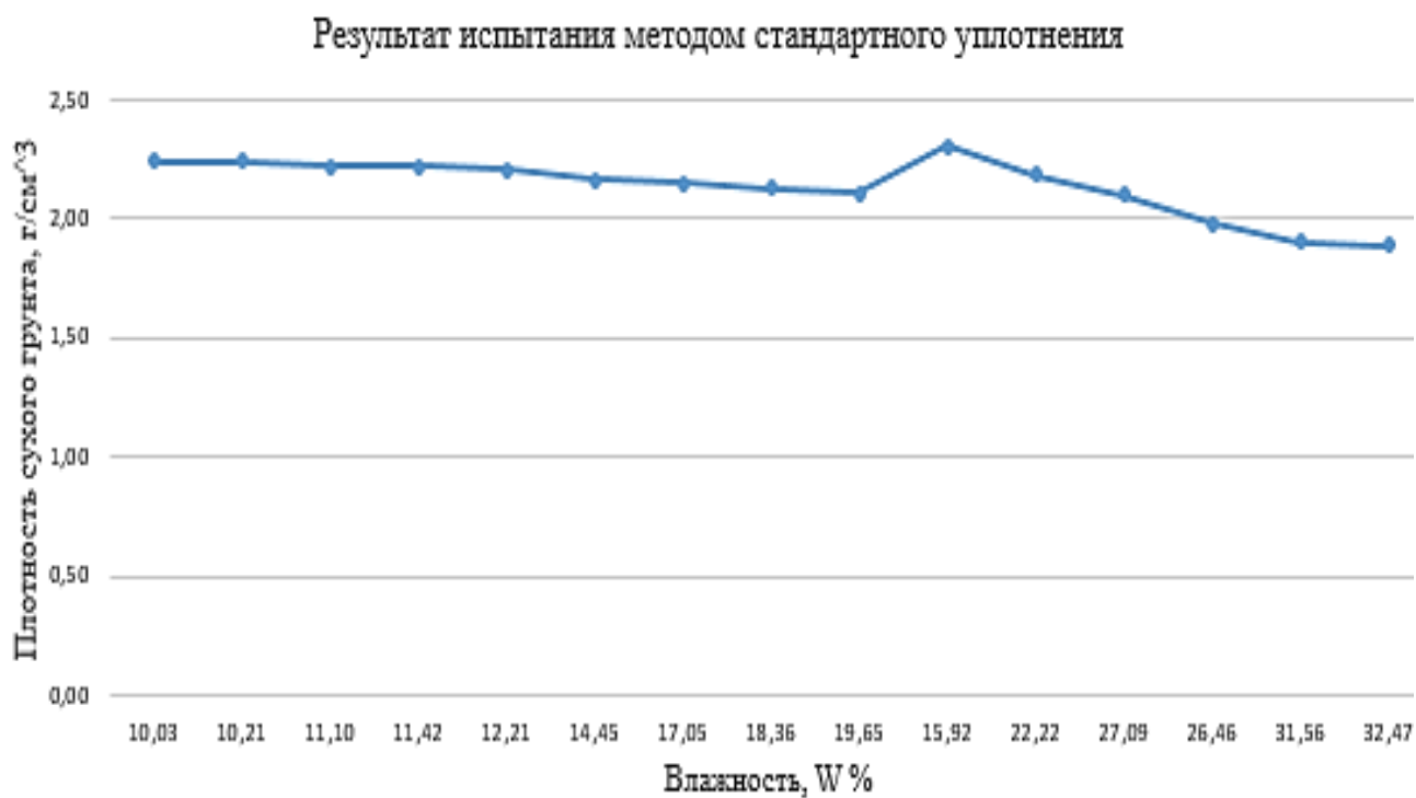
Рисунок А.1 – Графический результат испытания грунта методом стандартного уплотнения
