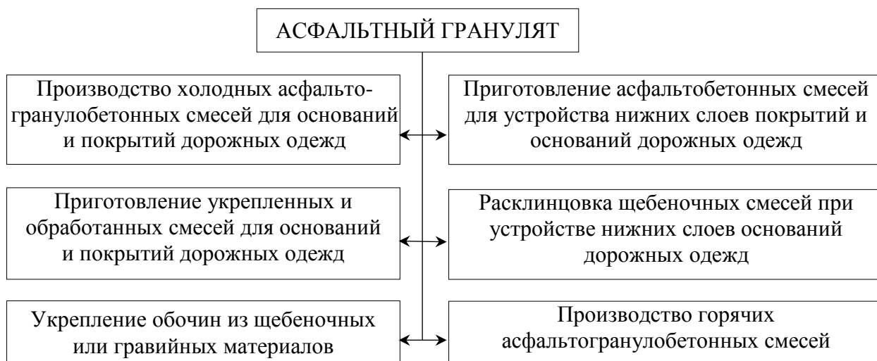
Рисунок 2.2 – Схема использования асфальтного гранулята
