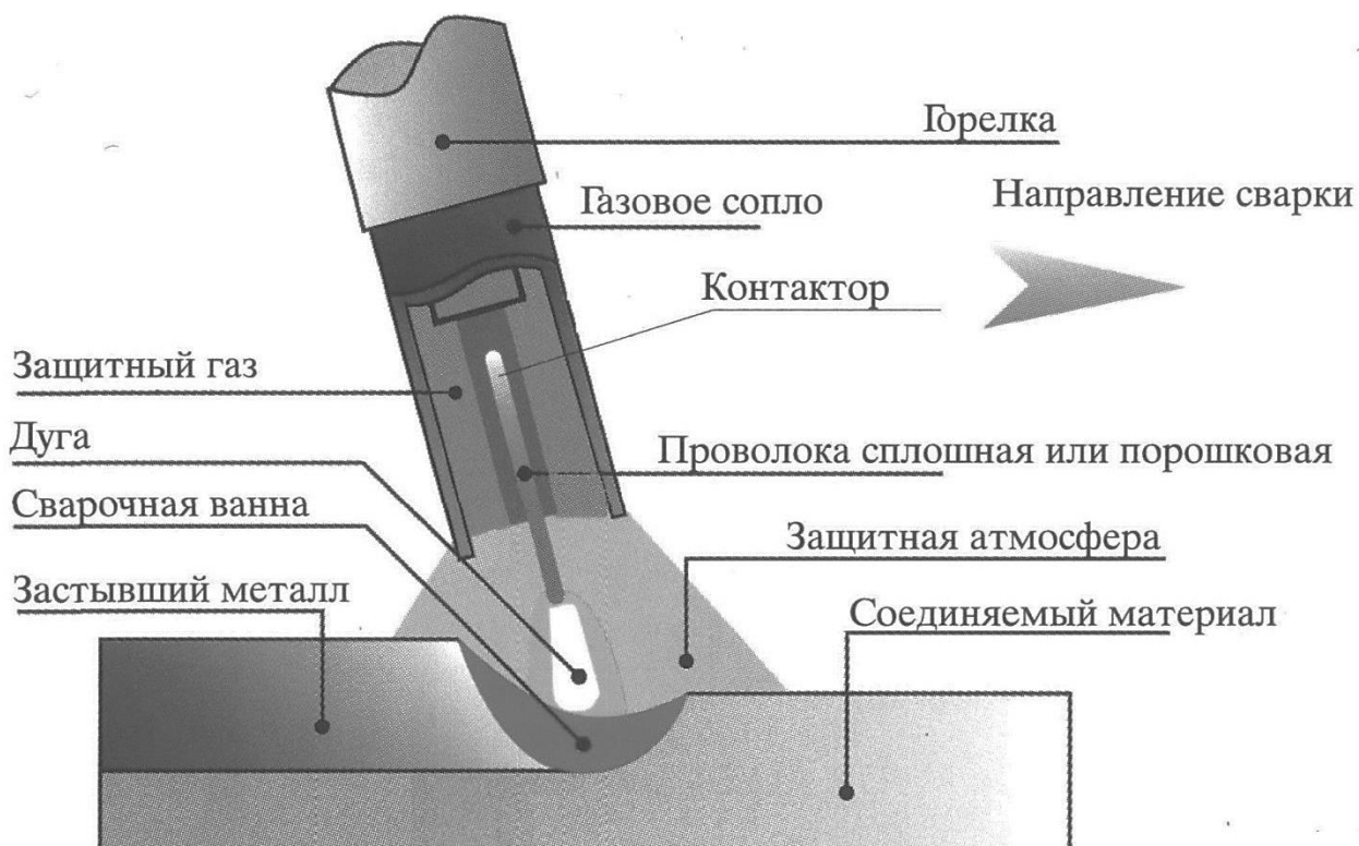
Рисунок 3.16 – Сварка в среде защитных газов
