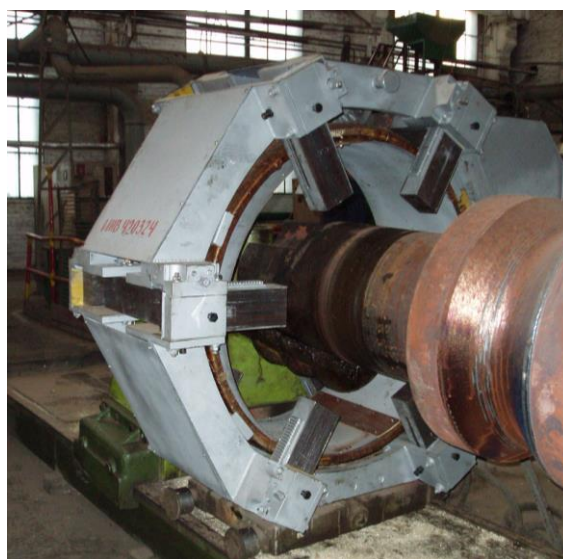
Рисунок 3.14 – Индуктор для нагрева под наплавку крупногабаритных деталей горнопромышленного оборудования
