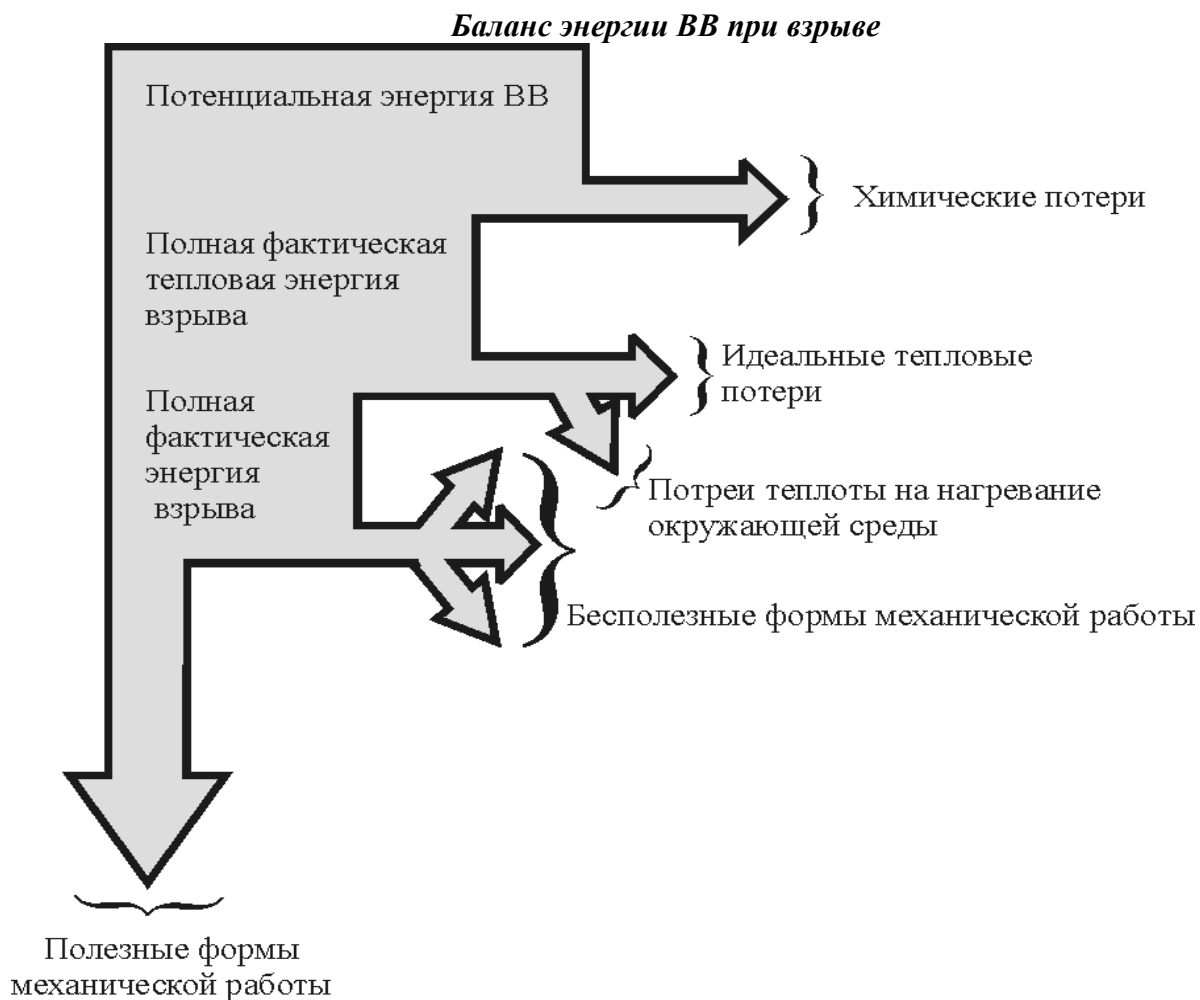
Рис. 4. Схема баланса энергии при взрыве (диаграмма работы взрыва)
