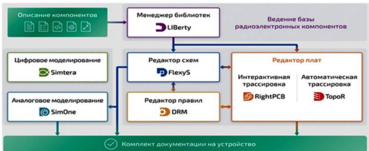
Рисунок 1 – Структура САПР электронных устройств Delta Design
