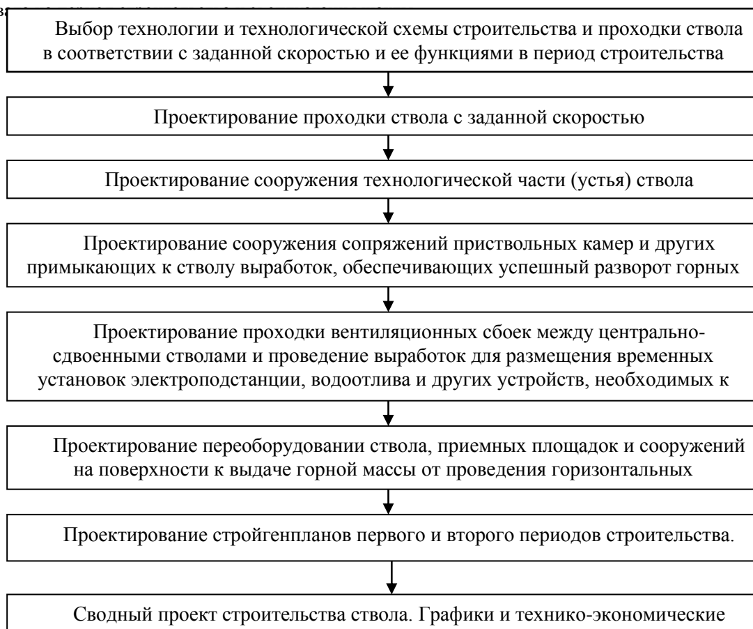
Рис. 34. Порядок проектирования строительства стволов шахт.
