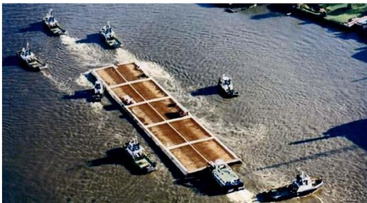
**Рис. 5.7** Транспортировка туннельной секции к месту установки
