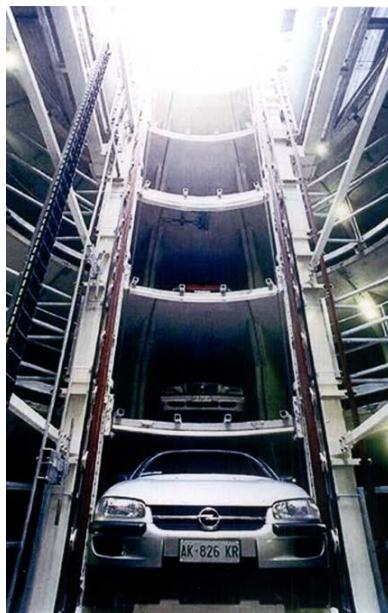
**Рис. 2.99 Подъемник лифтовой парковочной системы**
