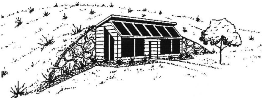
**Рис. 2.124** Схема заглубленного дома с одной открытой стеной
