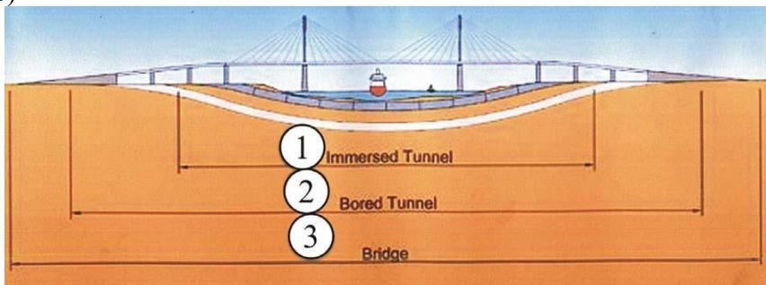
**Рис. 5.2 Сравнение подземного и погружного туннелей**
