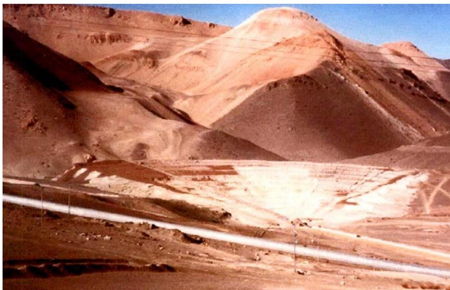
**Рис. 1.25 Отвалы продуктов обогащения шахты Ла Коипа (La Coipa), Чили (серебро, золото)**
