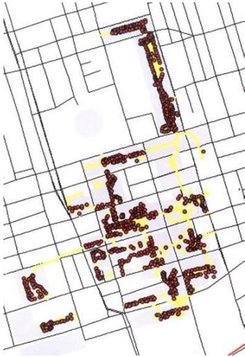
**Рис. 2.103** Схема размещения магазинов и сервисных служб в подземной пешеходной сети Торонто
