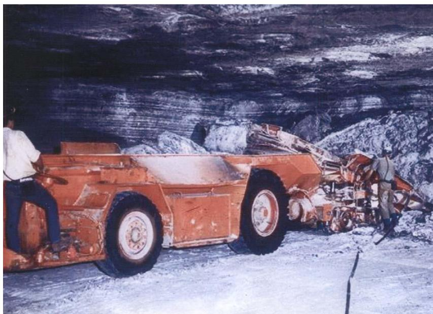
**Рис. 2.156** Погрузка породы после проведения взрывных работ
