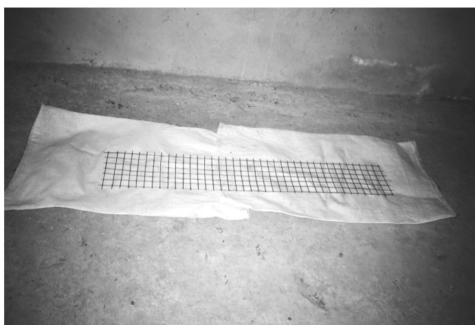
Рис. 4.2. Сварная сетка С-1
