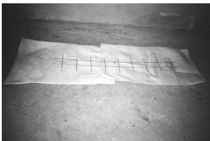
Рис. 4.3. Сварная сетка С-2
