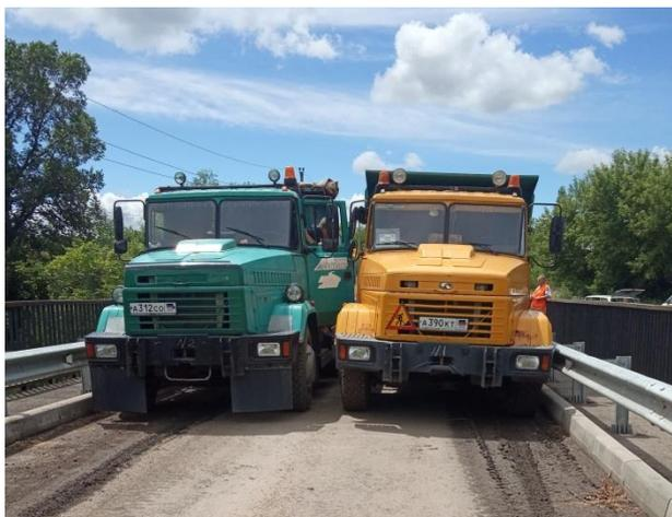
Рисунок 6 – Схема установки испытательной нагрузки
