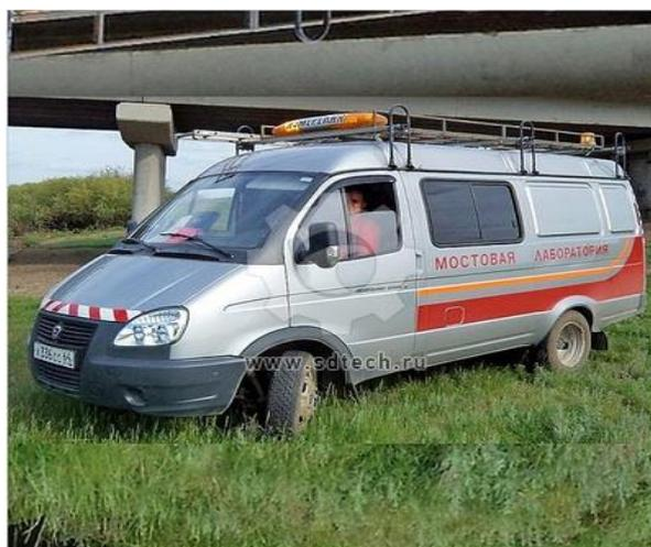
Рисунок 5 – Современная передвижная мостоиспытательная лаборатория КП-532
