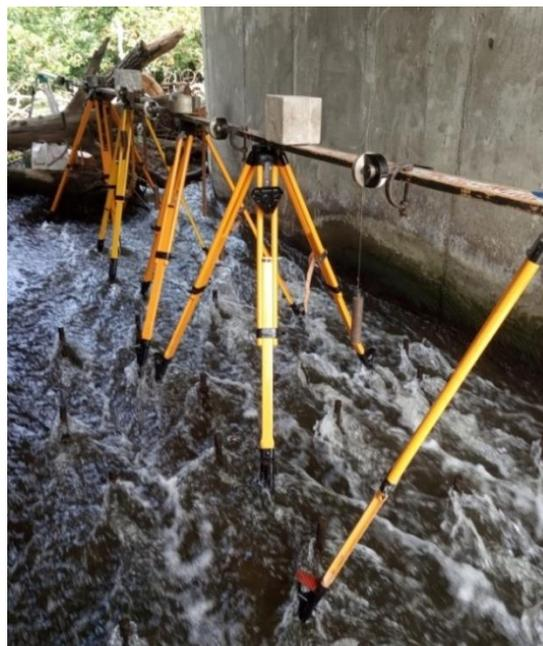
Рисунок 4 – Установка прогибомеров на специальной конструкции
