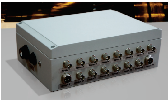
Рисунок 6 – Принципиальная схема универсального многоканального виброизмерительного комплекса UMS-16 (а), внешний вид универсального многоканального измерительного блока UMS-16 (б)
