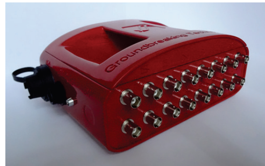
Рисунок 6 – Принципиальная схема универсального многоканального виброизмерительного комплекса UMS-16 (а), внешний вид универсального многоканального измерительного блока UMS-16 (б)
