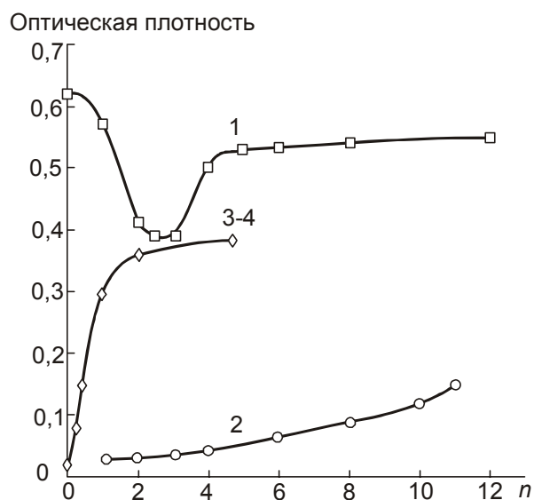
Рис. 4. Влияние концентрации CCl_3COOH : C_{Au} = 2,5 \cdot 10^{-4} М; l = 0,5 см. 1 – \lambda = 410 ; C_{MX} = 4,6 \cdot 10^{-4} ; 2 – \lambda = 450 ; C_{MX} = 4,6 \cdot 10^{-4} ; 3 – \lambda = 410 ; C_{MX} = 4,0 \cdot 10^{-4} ; 4 – \lambda = 450 ; C_{MX} = 4,0 \cdot 10^{-4}
