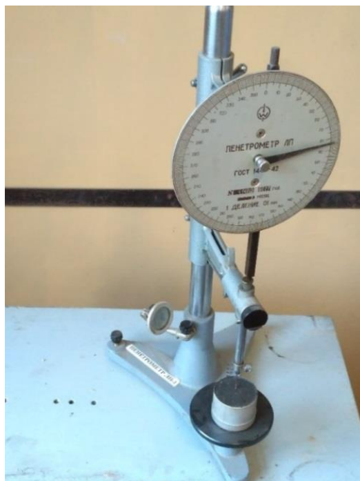
Рисунок 1 – Определение вязкости битума (пенетрометр)
