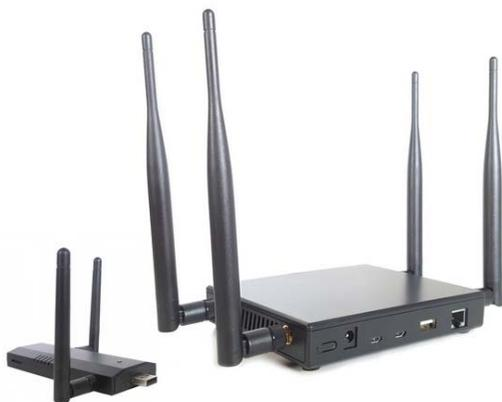
Рисунок 2 – Оборудование для атак на Wi-Fi сети
