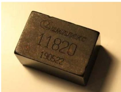
Рисунок 3 – Результат нанесения рисунка, серийного номера и даты на поверхность тестовой метки
