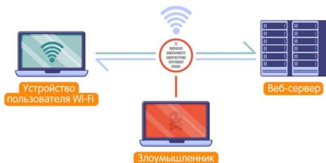
Рисунок 1 – Схема атаки «MITM»
