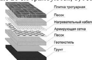
Рисунок 2 – Установка нагревательного кабеля при покрытии – тротуарная плитка
