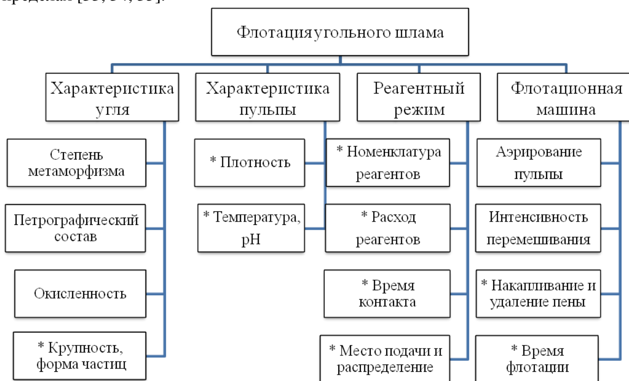
Рисунок 6.1. Технологические факторы, влияющие на флотацию углей
