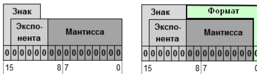
Рис. 4 Предлагаемая модификация формата чисел с плавающей запятой (на примере числа половинной точности): слева – традиционное представление, справа – формат с поддержкой постбинарного кодирования, содержащий на месте младших разрядов мантииссы код формата, что позволяет обеспечить гибкую разрядность и точность.
