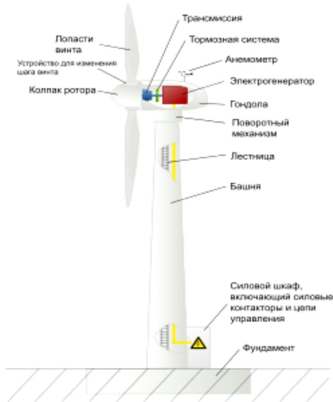
Рис.1. Промышленная ветровая установка
