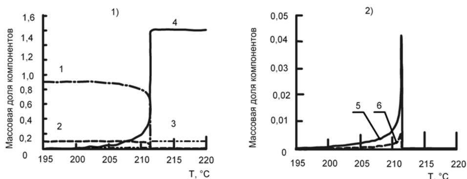
**Рис. 5.** Зависимость массовой доли компонентов в системе  $\text{LiNO}_3\text{-CaO-CO}_2$  от температуры (скорость нагрева 13 град/мин.). Исходное содержание  $\text{LiNO}_3$  10% мас.: 1 – CaO; 2 –  $\text{LiNO}_3$ ; 3 –  $\text{CaCO}_3$ ; 4 –  $\text{LiNO}_3(\text{ж})$ ; 5 –  $\text{LiNO}_3^*$ ; 6 –  $n\text{CaO}\cdot\text{LiNO}_3$
