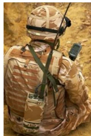
**MCTR-7200** (производитель Elbit Systems, Израиль) - компактный, легкий SDR трансивер, работающий в диапазоне частот 30-512 МГц, оснащенный интегральным, с высоким разрешением 2,8" цветным дисплеем, способным отображать потоковое видео, специально разработан для пехотных операций, с возможностью голоса радиосвязи и обмена данными с командованием и
