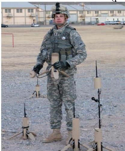
Рис. 6. «Разбрасываемый» датчик - тактический автономный наземный сенсор T UGS
