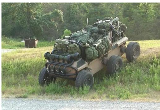
**Рис. 14.** Транспортная роботизированная машина MULE T XM1217
