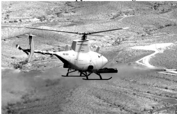
Рис. 5. БЛА XM157 Fire Scout. Пуск неуправляемой ракеты Hydra 70
