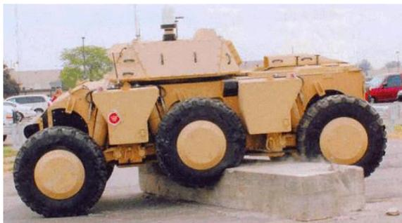
**Рис. 11.** Роботизированная машина APD - прототип тяжелой боевой роботизированной машины для программы «Боевая система будущего»
