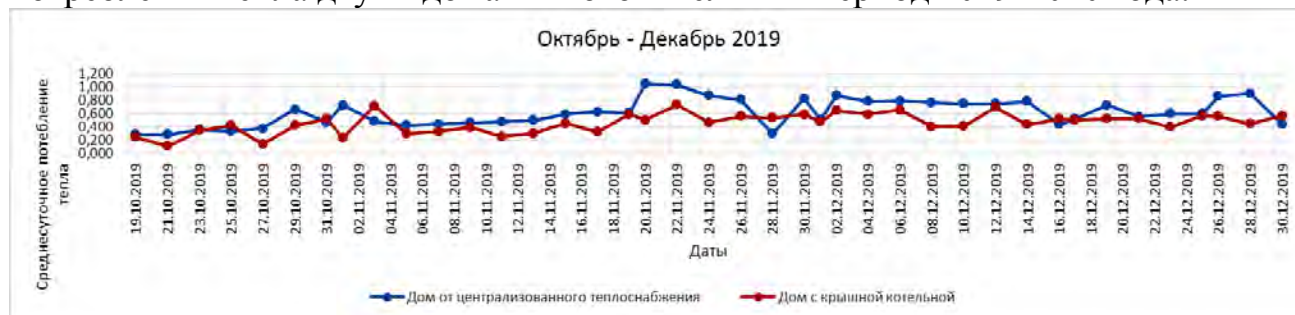
Рисунок 1. Графики сравнения среднесуточного потребления тепла двумя домами в период с октября по декабрь 2019 г.
