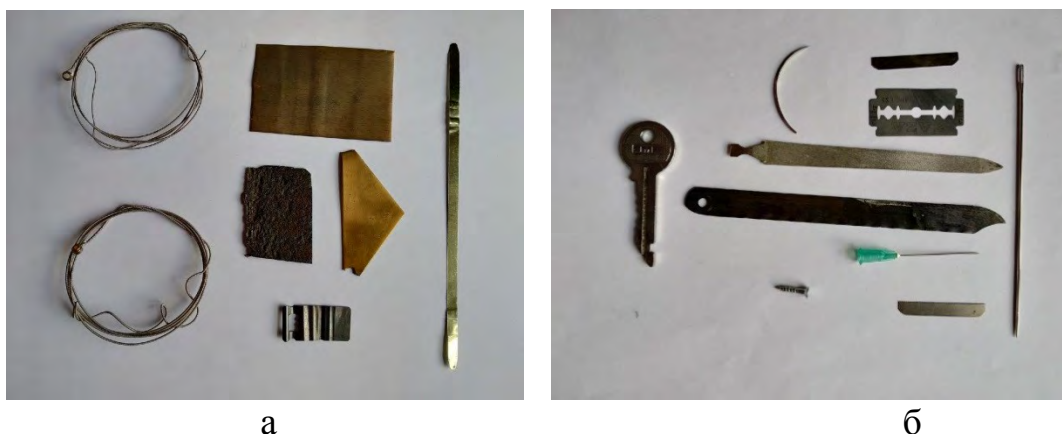
Рисунок 3 – Исходные материалы (а) и изделия (б) из сплавов, которые могут быть получены методом твердофазной металлургии
