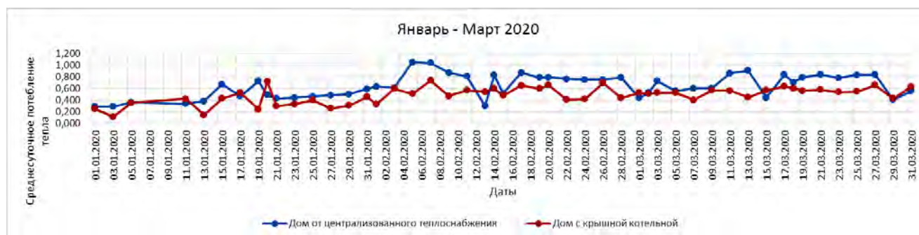
Рисунок 2. Графики сравнения среднесуточного потребления тепла двумя домами в период с января по апрель 2020 г.
