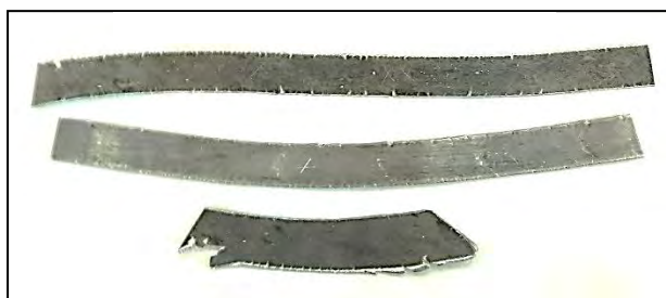
Рисунок 1 – Биметаллические вставки, полученные сваркой взрывом и последующей прокаткой
