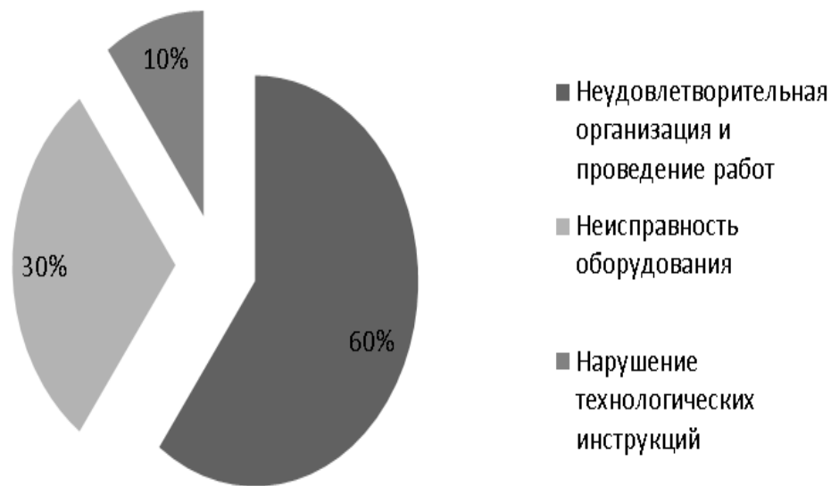
Рисунок 1 - Основные причины травматизма и других несчастных случаев на производстве черной металлургии в России
