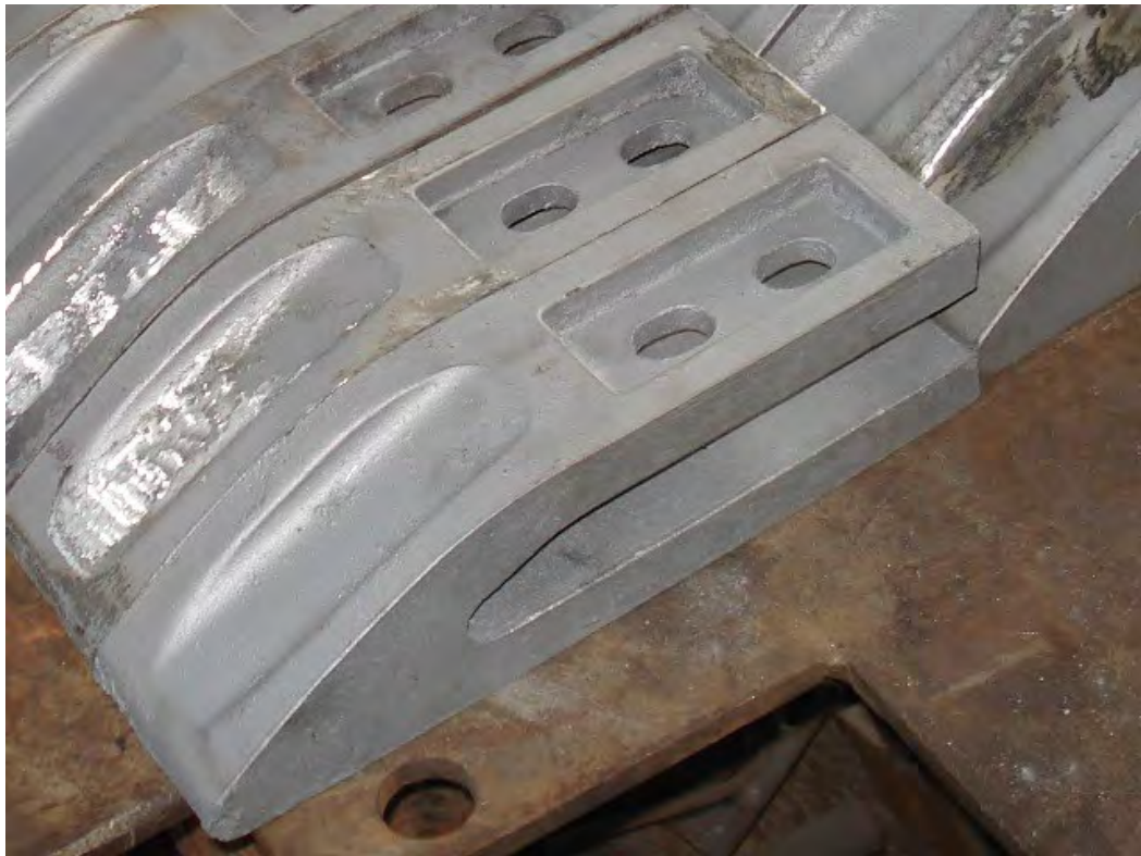
Рисунок 4 – Литая(ЛГМ) заготовка, зуб погрузчика согласно чертежа ЭС 11-48
