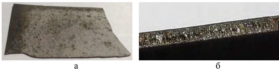
Рисунок 5 – Пластина борсодержащего сплава, полученная методом твердофазной металлургии (а – поверхность, б – излом)
