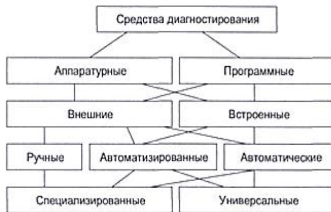
Рисунок 2. – Классификация средств диагностирования
