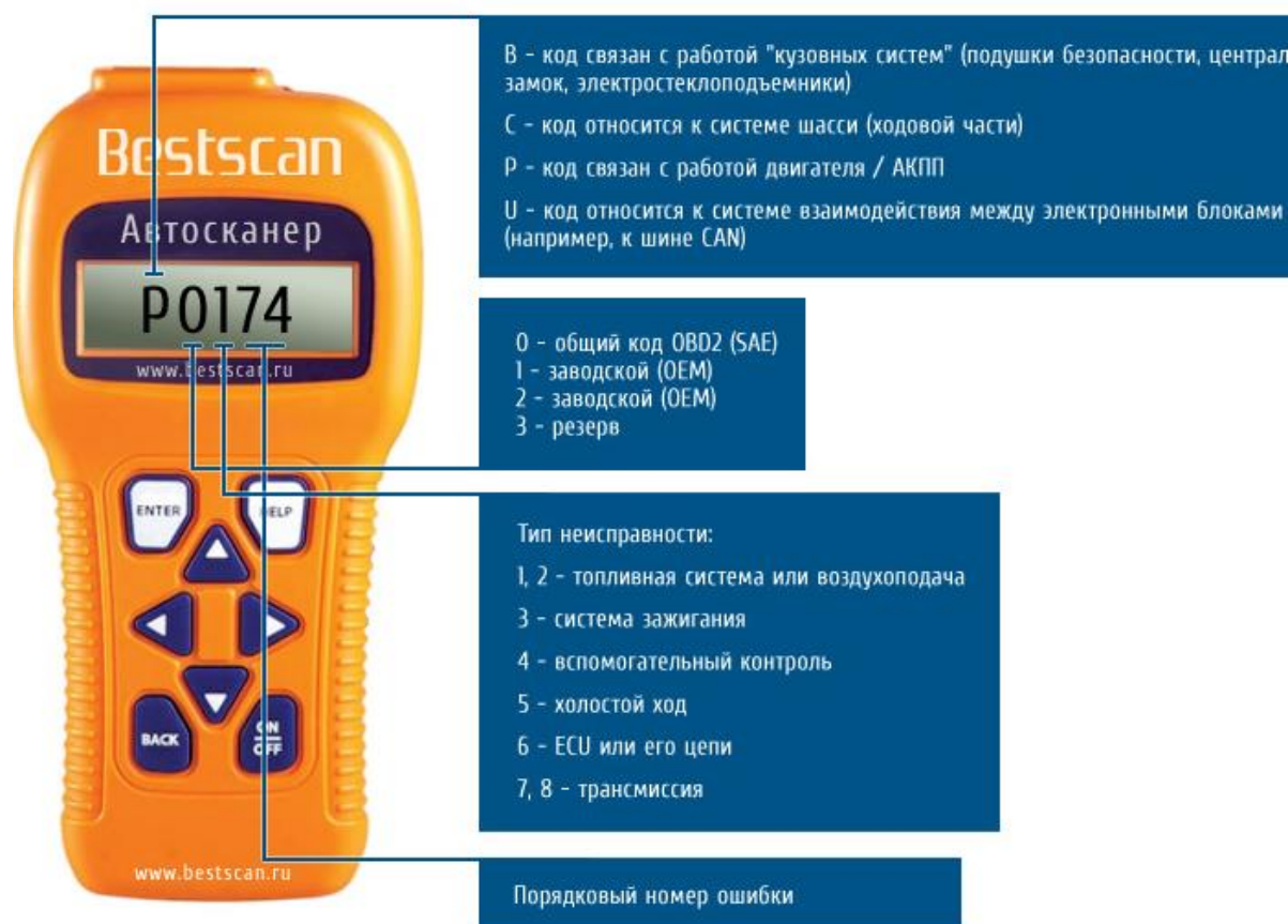
Рисунок 5. Пример расшифровки кодов ошибок
