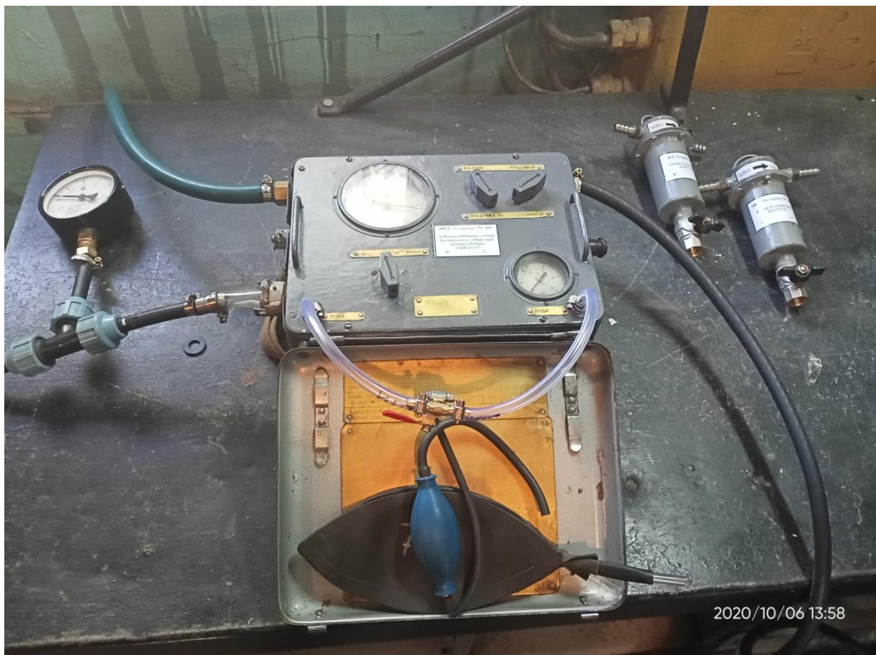
Рис. 3.12 – Составные части УСДОП в условиях учебно-тренировочного полигона подземного типа ОГВГСО г. Донецк МЧС ДНР (в здании на поверхности)
