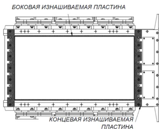
Рис. 12. Футеровочные пластины
