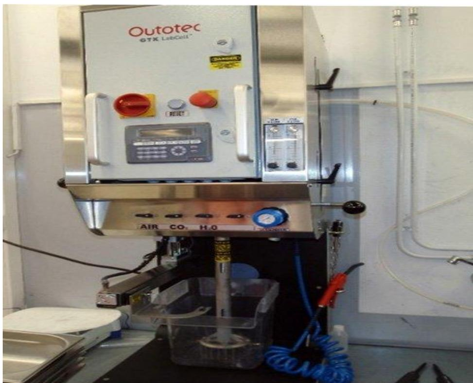
Рис.1. Лабораторная флотомашина Outotec GTK LabCell™
