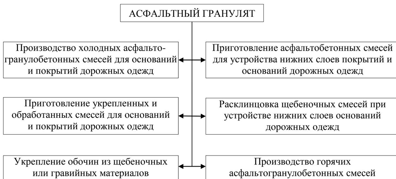
Рисунок 1 – Схема использования асфальтного гранулята
