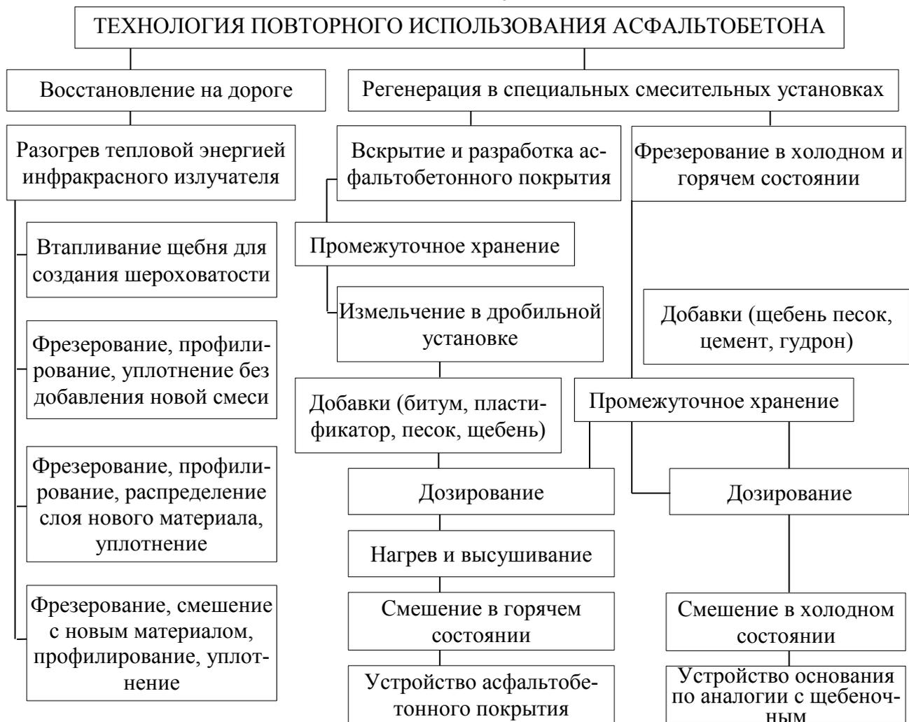
Рисунок 3 – Схема повторного использования асфальтобетона
