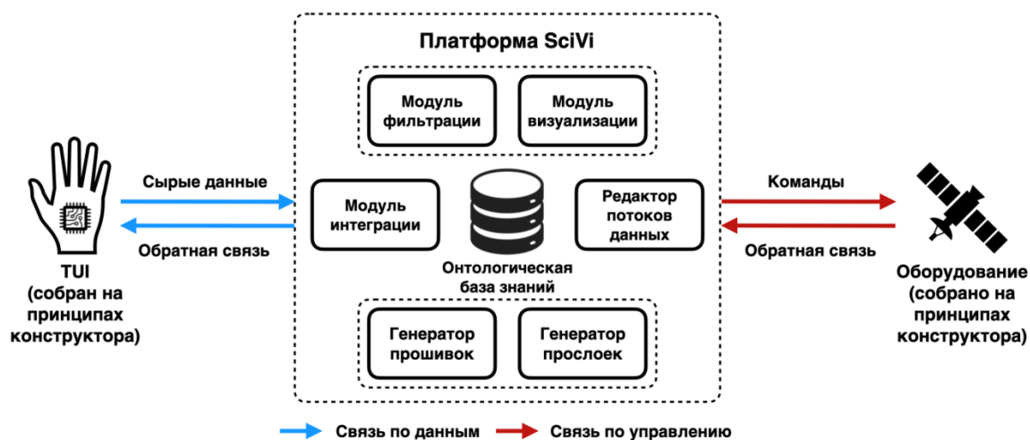
Рис. 1. Организация онтологически-управляемого TUI к космическому оборудованию.
