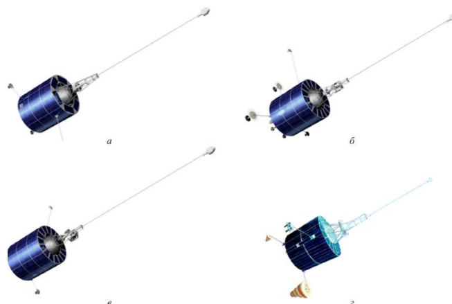
Рис. 1. Космические аппараты навигационных систем первого поколения: а) КА «Циклон»; б) КА «Циклон-Б»; в) КА «Цикада»; г) КА «Надежда».
