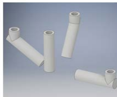
Рисунок 2 - Модель формы для литниковой системы а) 3D модель формы, б) 3D модель изложницы
