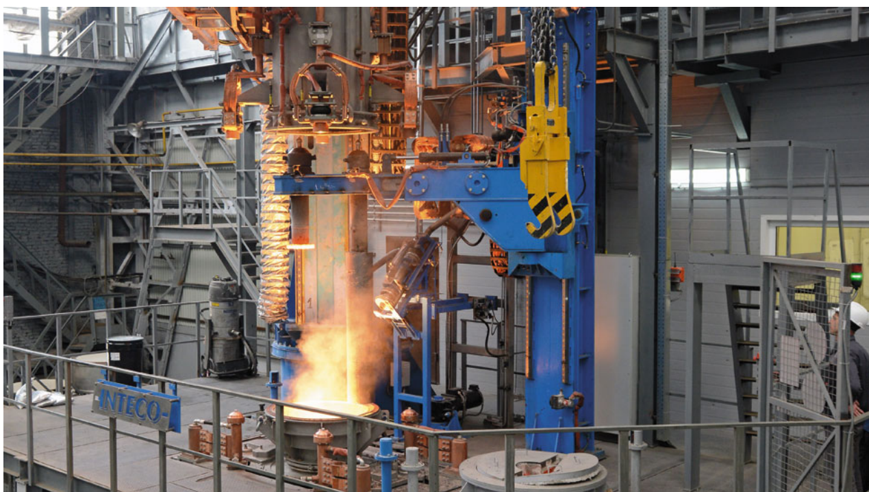
Рисунок 1 – Печь электрошлакового переплава ПАО «Русполимет»
