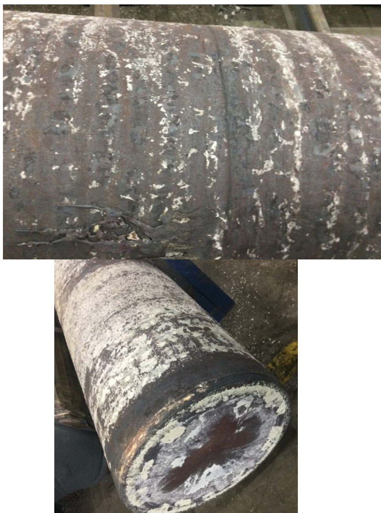
Рисунок 2 – Дефекты поверхности слитка ЭШП плавки №1: подтек металла (слева); плохое отслаивание шлаковой корочки (справа)
