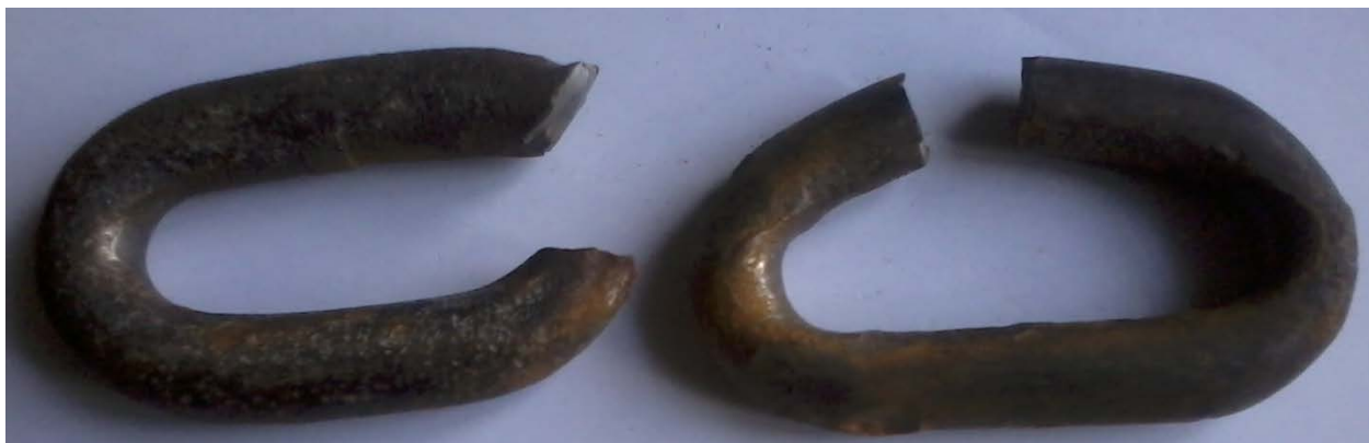
Рис.5 – Разрушенные круглые звенья цепи шахтного конвейера
