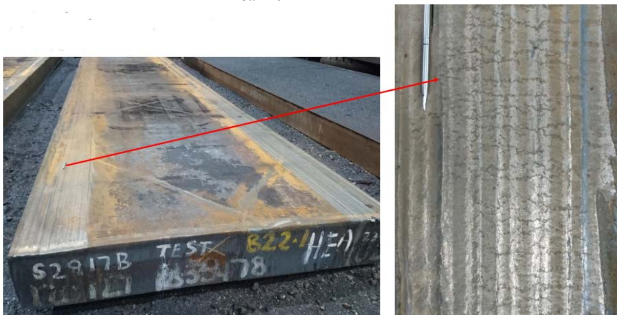
Рисунок 2 – Поперечные трещины со стороны большого радиуса УНРС после зачистки
