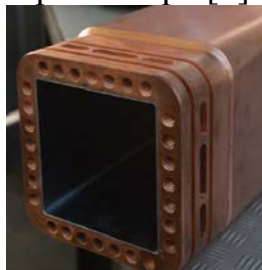
Рисунок 3 – Внешний вид гильзы, разработанной фирмой «Danieli», со сквозными отверстиями по периметру
