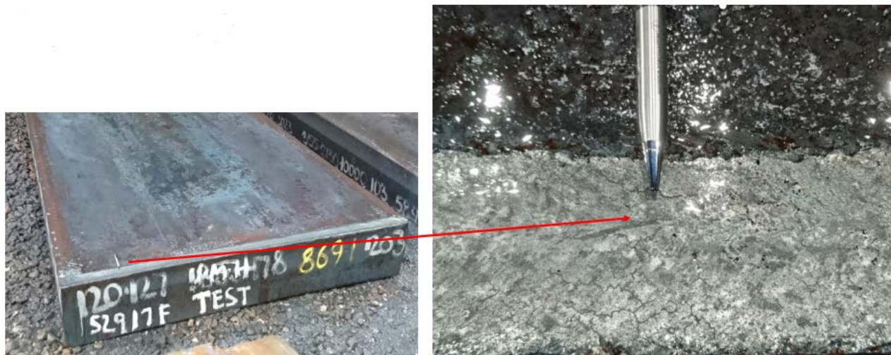
Рисунок 1 – Поперечные трещины вдоль продольной кромки сляба после зачистки
