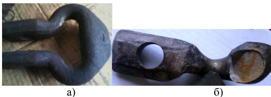
Рисунок 1-Общий вид соединительного звена до(а) и после разрушения(б)
