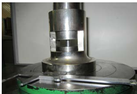
Рисунок 3 - Специальная штамповая оснастка типа «стакан» для осадки цилиндрических образцов
