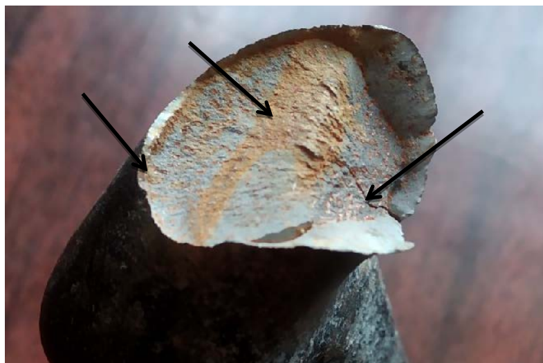
Рис.2 – Излом соединительного звена шахтного конвейера: а – начальный участок излома; б –участок развития излома; в – зона долома.
