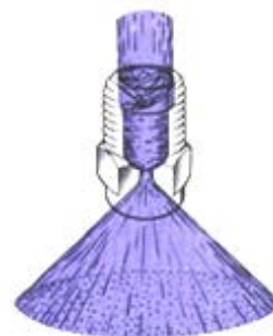
Рисунок 4 – Внешний вид форсунки, разработанной фирмой «Lechler», и схема факела водовоздушной смеси
