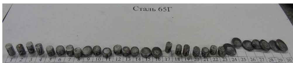
Рисунок 2 - Натурные образцы после осадки в штампе
