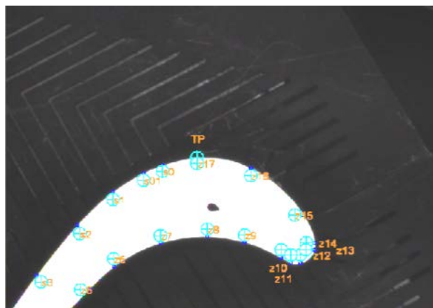
Рисунок 3 - Пример деления контура торца лопатки на сегменты
