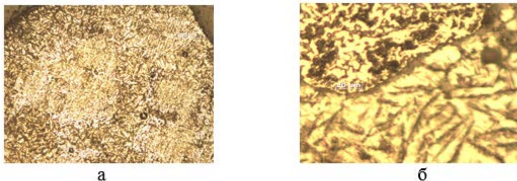
Рисунок 1 – а) Микроструктура системы титана и углеродного волокна с защитой, x10, б) - Микроструктура системы т
