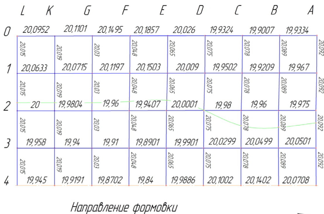
Рисунок 5 – Развертка деформированной координатной сетки на участке первой формовочной клетки (внешняя сторона)
