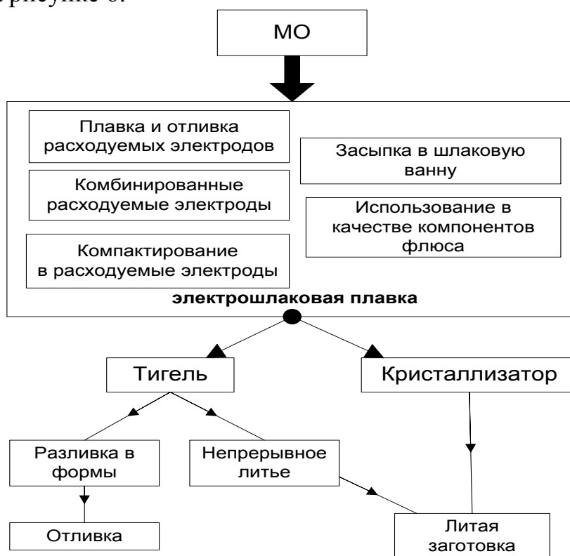
Рисунок 6 – Схема возможных технологических цепочек переработки МО электрошлаковой плавкой
