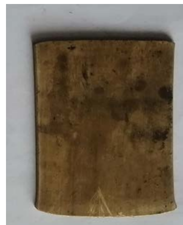
Рисунок 3 - Образцы из латуни Л63 с суммарной степенью обжатия \epsilon=25\% при различных режимах прокатки:
