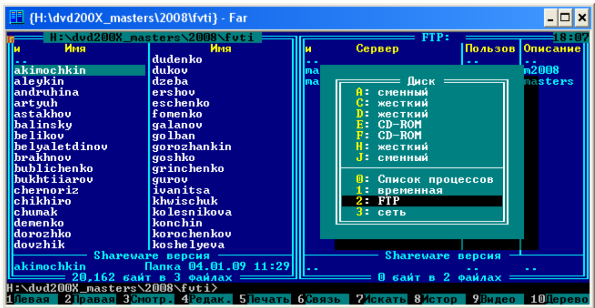
Рис. 4 – Меню, выводимое при нажатии комбинации клавиш <Alt>F2. Выделен пункт, выбираемый для подключения к серверу по протоколу FTP
