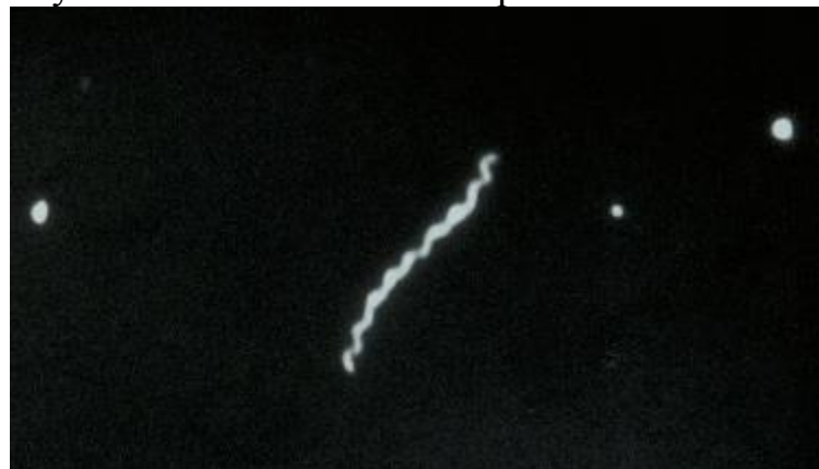
Рисунок 6 – Шлиф с микротрещиной и неметаллическими включениями. Темнопольное изображение
