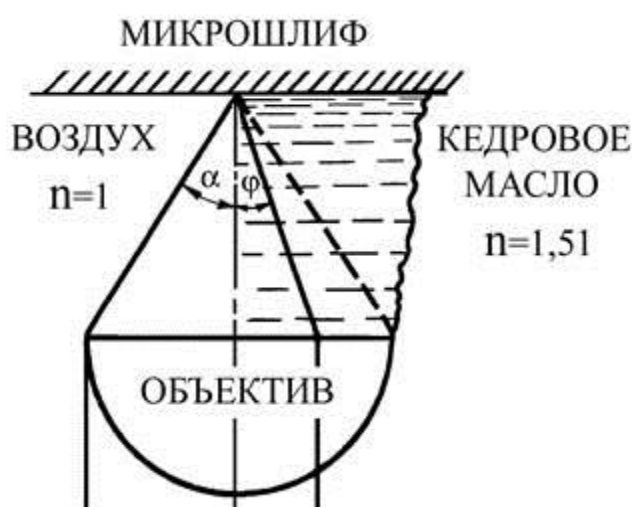
Рисунок 3 - Влияние коэффициента преломления среды на ход световых лучей в сухом и иммерсионном объективе
