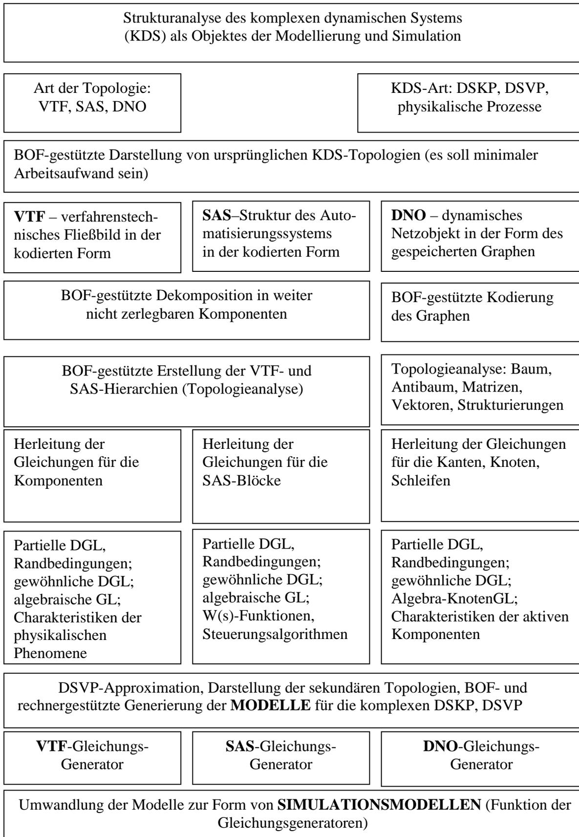
Abb. 2. Etappen der rechnergestützten Entwicklung von DSKP-, DSVP-
