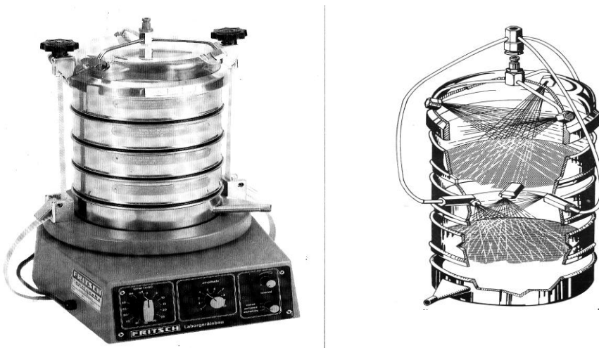
Рисунок 2.4 – Вибрационный анализатор для мокрого отсева сыпучих материалов фирмы Fritsch
