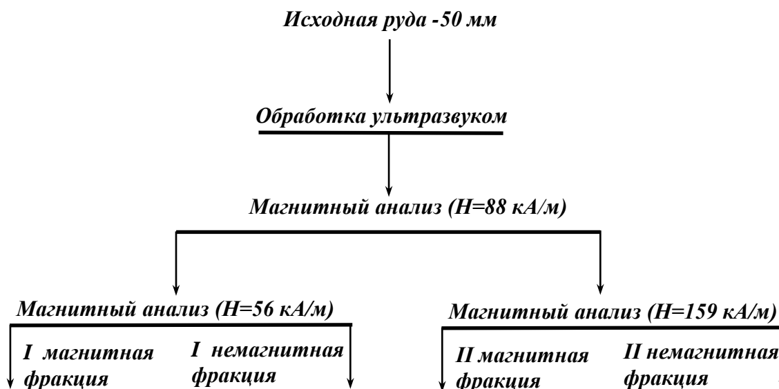
Рисунок 4.2 – Схема магнитного анализа сильномагнитных руд крупностью до 1 мм
