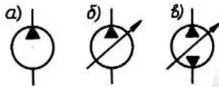
Рис. 1.5. Условные обозначения гидронасосов: а - нерегулируемый насос; б, в - регулируемый с постоянным /б/ или переменным /в/ направлением потока
