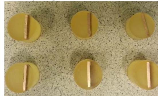
Рисунок 1 - Науглероженные и полированные образцы медных пластин коллектора тягового электродвигателя
