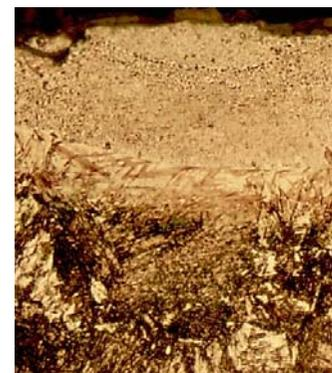
Рис. 3. Микроструктура цементируемого слоя при покрытии с 30% жидкого стекла( $V = 5\text{мм/с}$ .)
