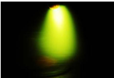
Рисунок 7 - Фото пятна нагрева выполненного при силе тока дуги 70 А
