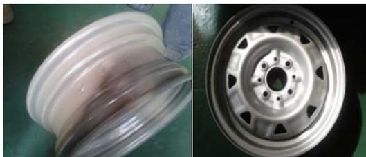
Рисунок 2 - Внешний вид колеса автомобиля «ВАЗ», полученного из опытной партии горячекатаной травленной дрессированной ленты из стали марки 07ГБЮ
