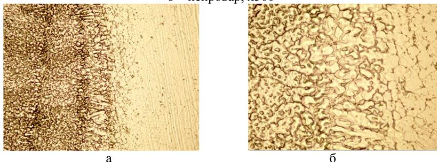
Рисунок 2 – Микроструктура сварного шва стали 12X18H10T, РДС, линия сплавления: а – x200; б – x500
