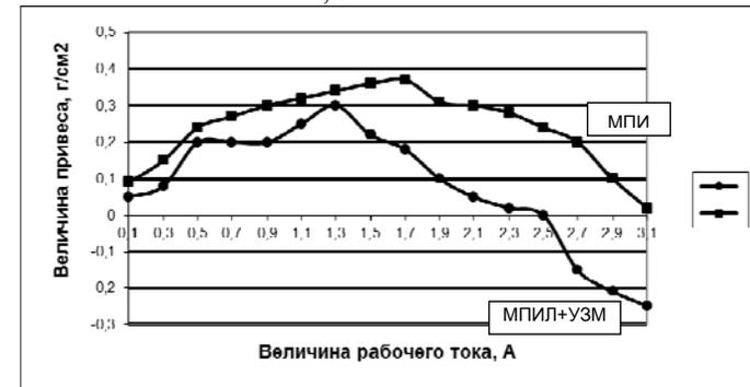
Рисунок 2 - Влияние схемы обработки и энергетических параметров микроплазменского легирования на дезерозию катода
