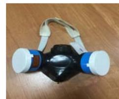
Рис.3 Насадка и патрон в сборе
