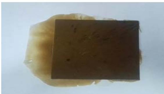
Рисунок 2 - Образец композиционного материала (PLA + древесная мука)
