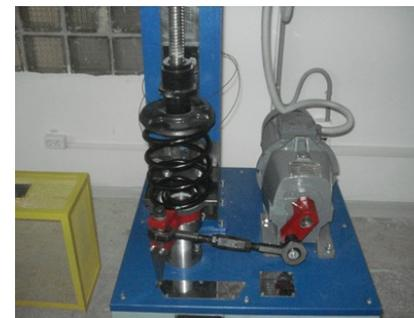
Рисунок 3 - Стенд для ресурсных испытаний подшипников 1118-2902840-04
