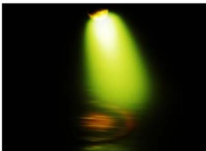
Рисунок 6 - Фото пятна нагрева выполненного при силе тока дуги 50 А
