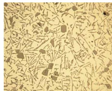
Рисунок 2 – АК12 до модифицирования, х200: кристаллы кремния и грубая эвтектика [α+Si]
