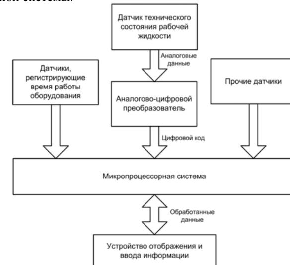
Рисунок 1 - Структура информационно-измерительной системы диагностики состояния рабочей жидкости
