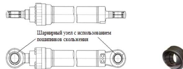
Рисунок 1 - Гидравлический цилиндр с шарнирными подшипниками
