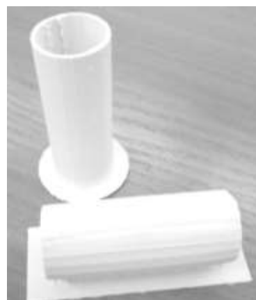
Рис. 3. Вертикальное и горизонтальное положение печати детали «трубка»
