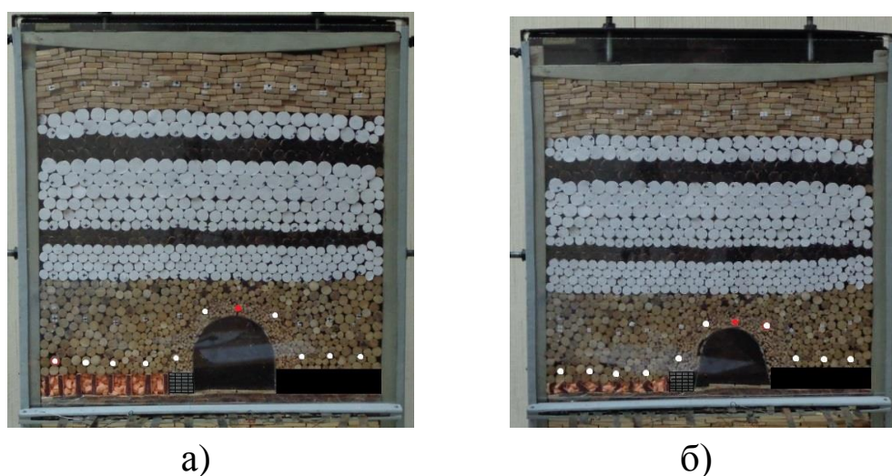
Рис. 5. Общий вид моделей на начальном (а) и конечном (б) этапах нагружения для средней части выработки (репер № 6)
