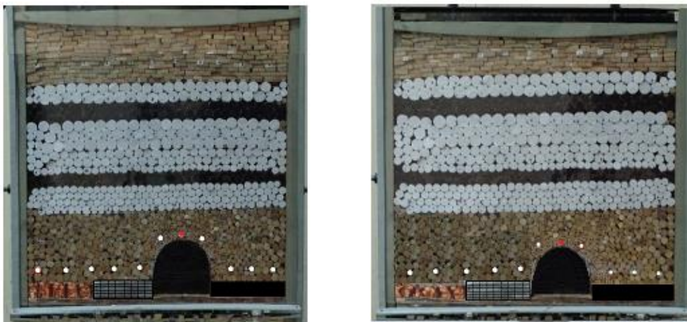
Рис. 7. Общий вид модели № 4 на начальном и конечном этапах нагружения для средней части выработки (репер № 6)
