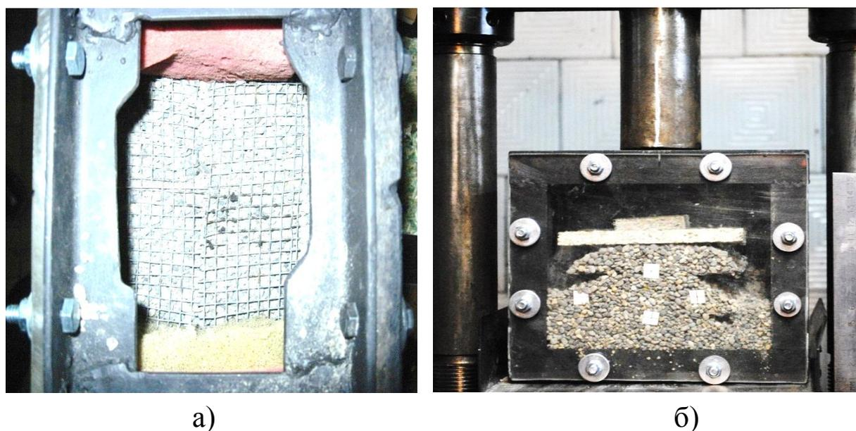
Рис. 2. Лабораторные исследования модели в процессе формирования: а) охранного сооружения; б) испытания
