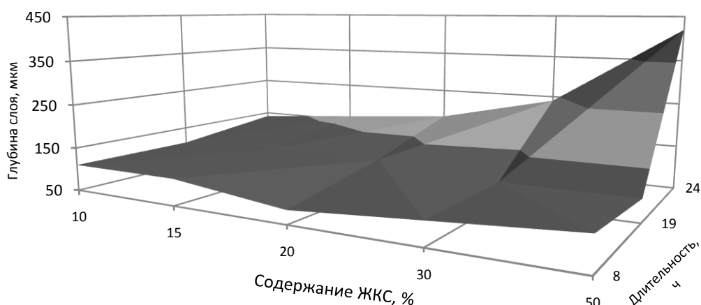
Рисунок 1 – Влияние длительности обработки и содержания желтой кровяной соли на глубину слоя
