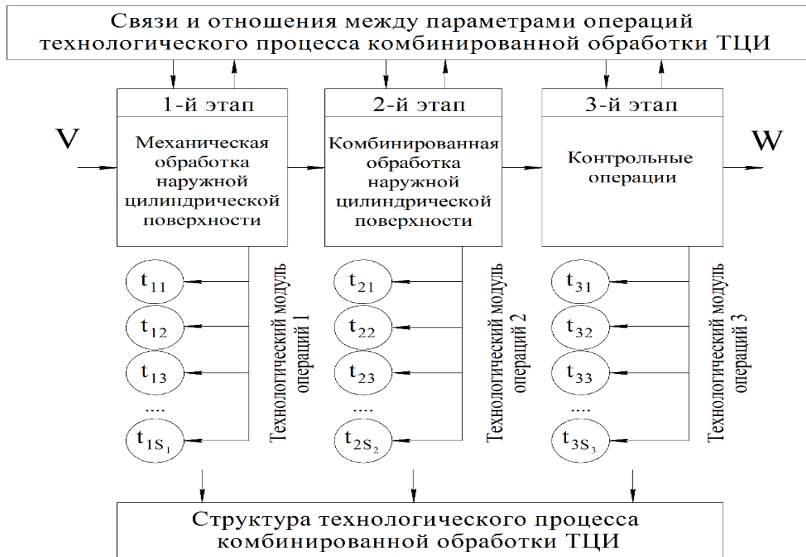
Рисунок 5 – Общая укрупненная универсальная структура технологического процесса ультразвуковой обработки тонкостенных цилиндрических изделий
