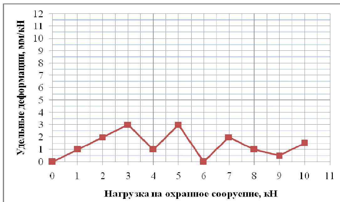
Рисунок 8 – График зависимости удельных деформаций от величины нагружения (с заполнением пустот между отдельными элементами конструкции деревянными кругляками)
