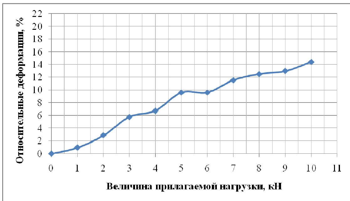
Рисунок 7 – График зависимости относительной деформации от величины нагружения (с заполнением пустот между отдельными элементами конструкции деревянным кругляком)
