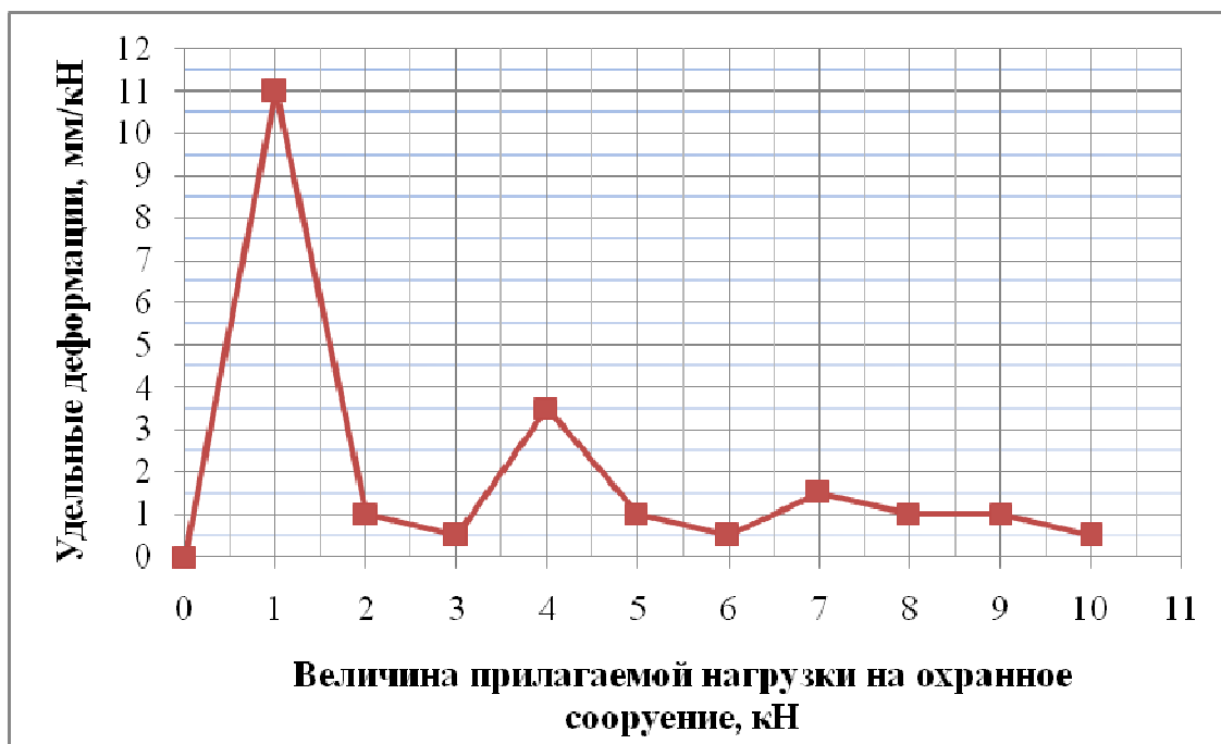
Рисунок 4 – График зависимости удельных деформаций от величины нагружения (без заполнения пустот между отдельными элементами охранного сооружения)
