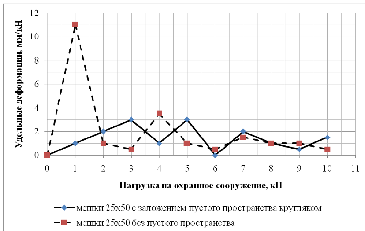
Рисунок 9 – График зависимости удельных деформаций охранной конструкции от величины нагружения
