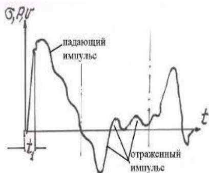
Рис. 2.2. Формирование падающего и отраженного импульсов при ударном бурении.
