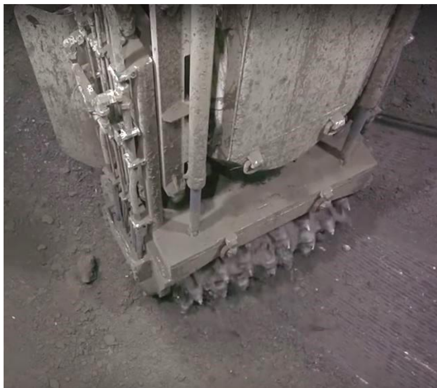
Рис.7. - Фотография исполнительного органа SBR.
