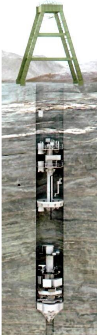
Рис.2. - Проходка ствола комплексом SBE по передовой скважине.
