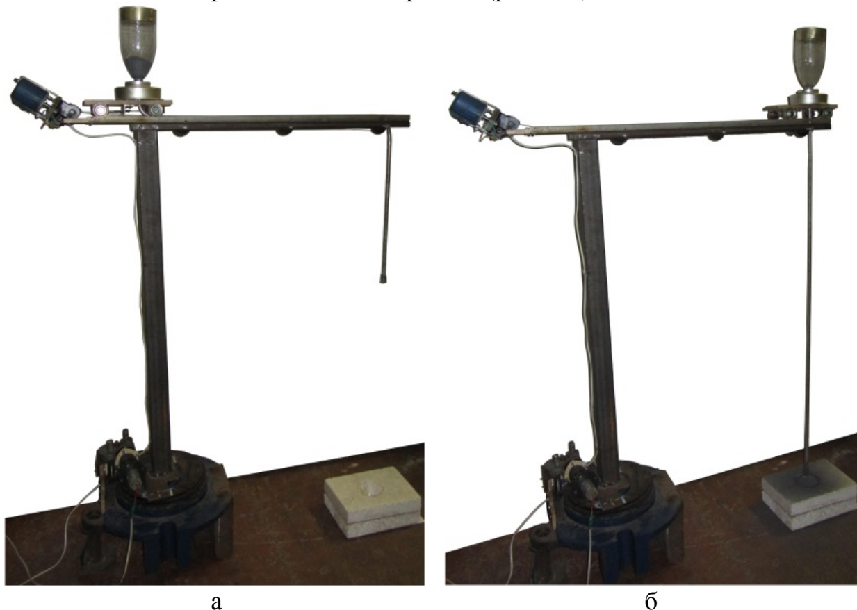
Рисунок 1 – Физическая модель системы механизированной подачи стартовой смеси в канал ковшового затвора в исходном (а) и конечном (б) положениях [10]
