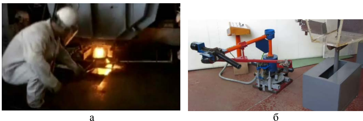
Рисунок 2 – Замена погружного стакана на слябовой МНЛЗ вручную (а) и физическая модель системы быстрой смены защитного огнеупора (б) (патенты UA 96891 и UA 104227)
