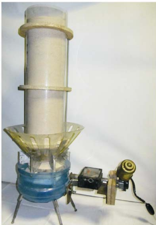
Рис. 3. Физическая модель разработанной системы выгрузки извести из шахтной обжиговой печи
