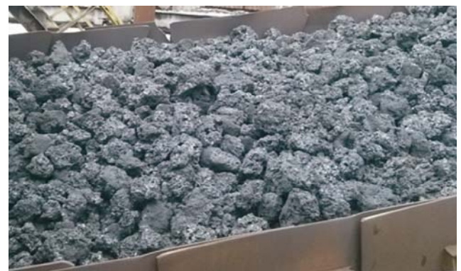
Рис. 3. Слой агломерата на линейном охладителе “Северстали”, прямая система загрузки, 2016 г.
