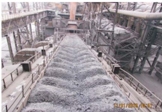
Рис. 4. Слой агломерационного спека на линейном охладителе АМТ, обратная система загрузки, 2016 г.
