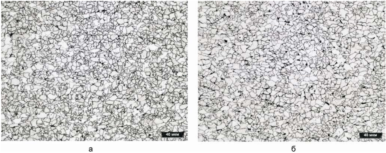
Рис. 2. Характерная микроструктура проката (а) и труб (б) из стали А
