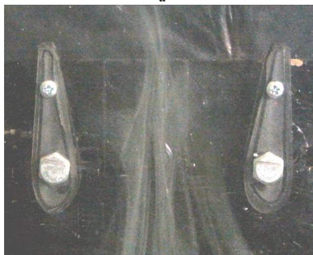
Рис. 3. Поля скоростей газозвдушного потока на различном удалении от выхода горловины плоской модели вентиляторной системы – а и визуализированная картина в зоне формирования – б при давлении и объемном расходе энергоносителя 50 кПа и 8 л/мин
