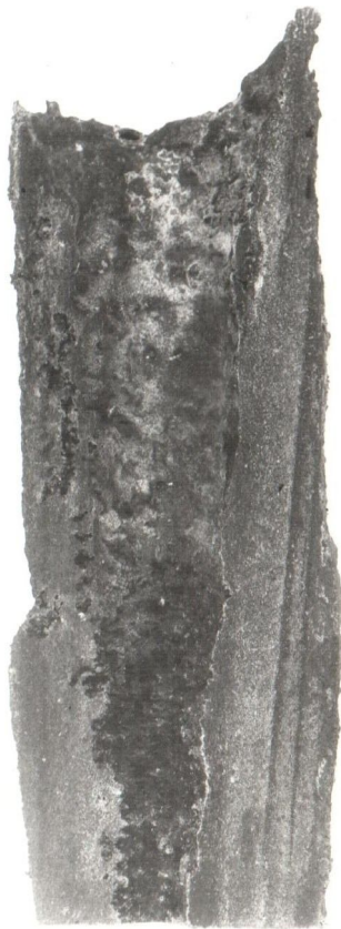
Рисунок 1 – Продольный разрез настыли, извлеченной из канала ковшового затвора
