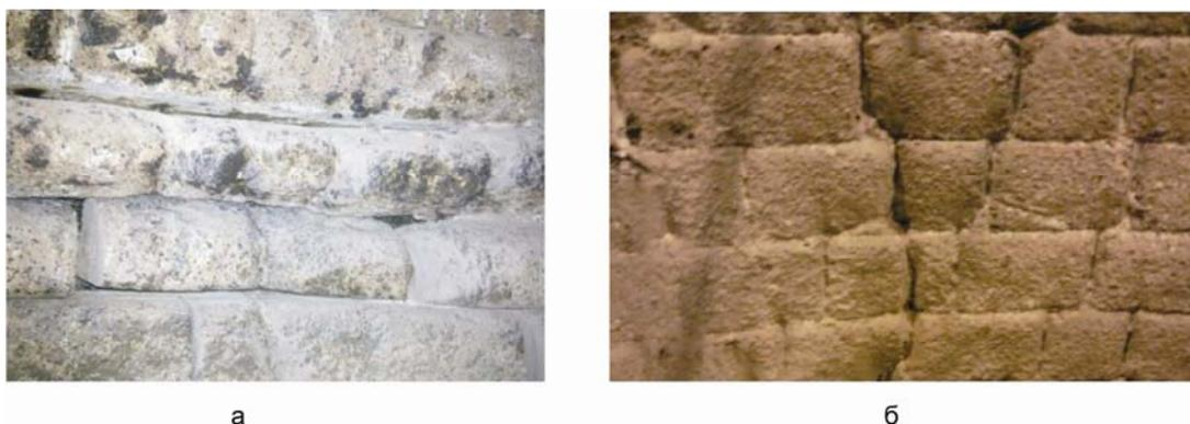
**Рис. 6.** Внешний вид подшлаковой области футеровки стенки ковша над продувочным узлом (а) и растрескивание ее рабочего слоя (б)
