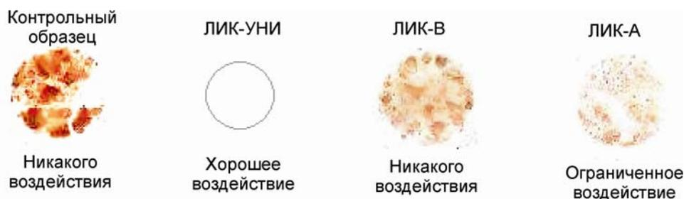
**Рис. 4.** Результаты испытания защитного действия упаковочных бумаг на коррозию холоднокатаной стали в период консервации
