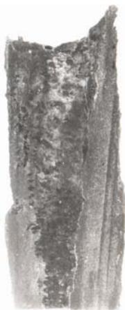
**Рис. 1.** Продольный разрез настыли, образовавшейся в канале разливочного стакана при его зарастании
