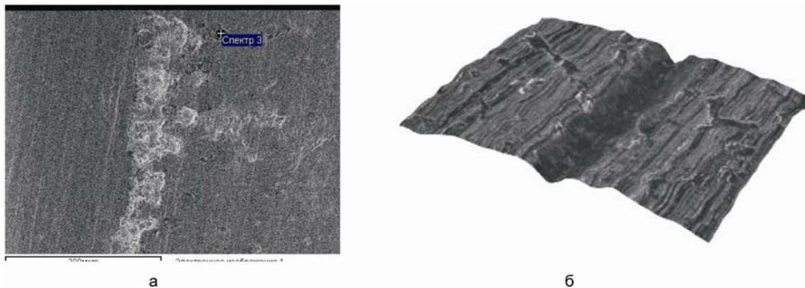
**Рис. 3.** Дефект на поверхности холоднокатаного листа — разрез по Z — по линии поперек риски: а — внешний вид дефекта; б — изменение рельефа внутренней поверхности дефекта
