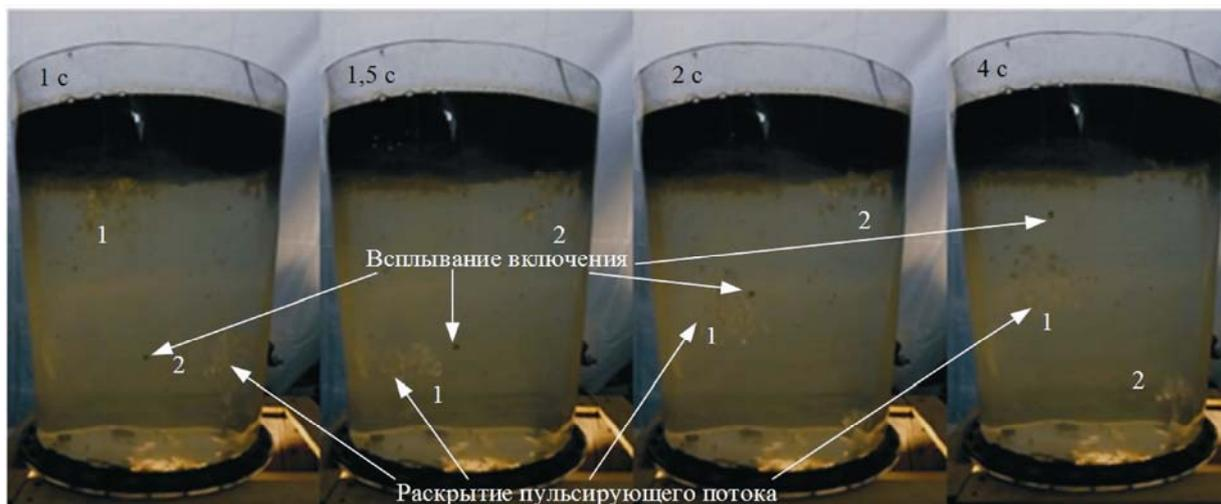
**Рис. 4.** Характер поведения жидкости и неметаллических включений при пульсирующей схеме продувки через 1; 1,5; 2 и 4 с от начала опыта:
