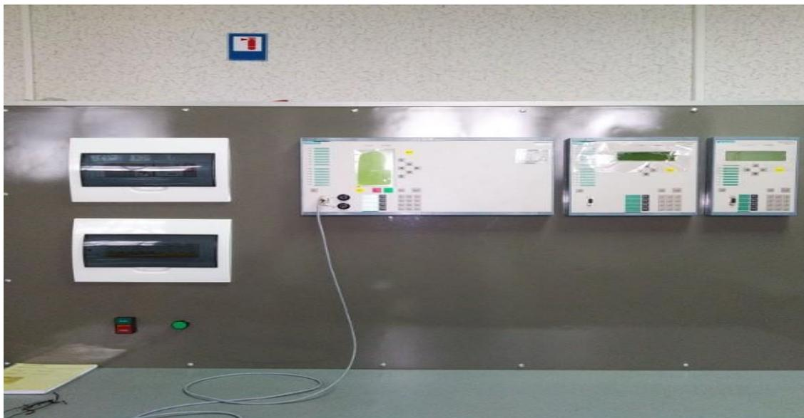
Рисунок 3 – Лабораторный комплекс по исследованию цифровых систем дифференциальной и дистанционной защит
