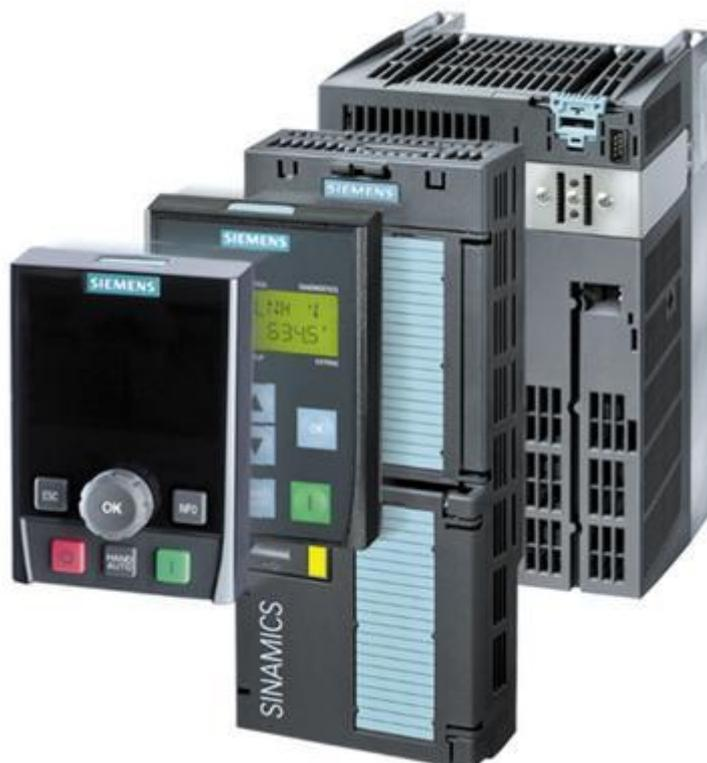
Рисунок 1 – Модульная структура преобразователя частоты Sinamics G120.
