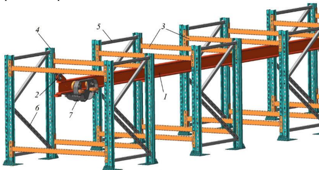
Рисунок 1 – Общий вид мобильной подвесной монорельсовой дороги: 1 – монорельс; 2 – проушина отрезка монорельса; 3 – горизонтальные балки; 4 – стойка; 5,6 – горизонтальная и наклонная связи; 7 – тележка
