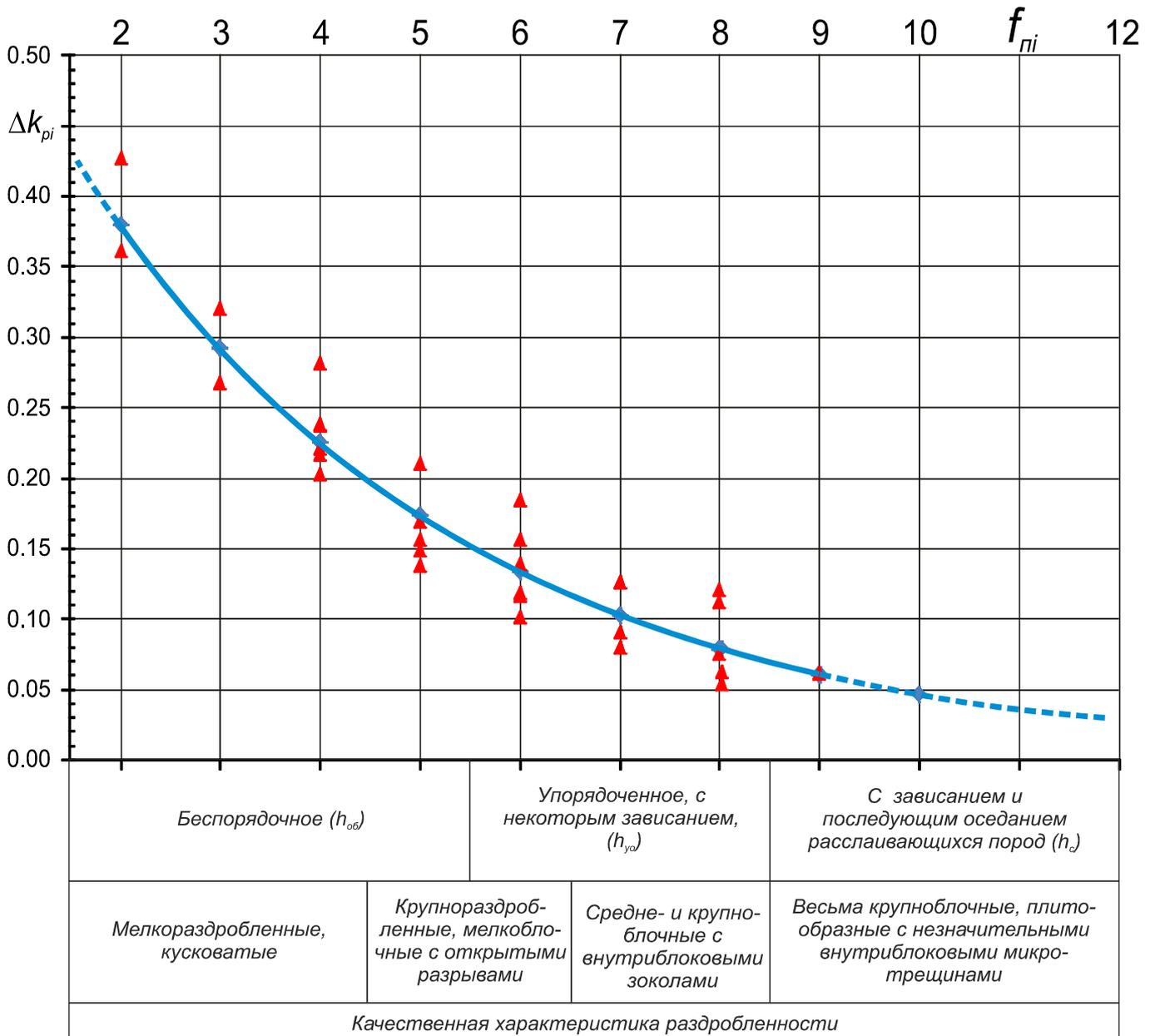
Рисунок 1. Графическая интерпретация эмпирической связи коэффициентов  $\Delta k_{pi}$  и  $f_{pi}$  с указанием признаков качественных характеристик раздробленности разрушенных естественным путем пород
