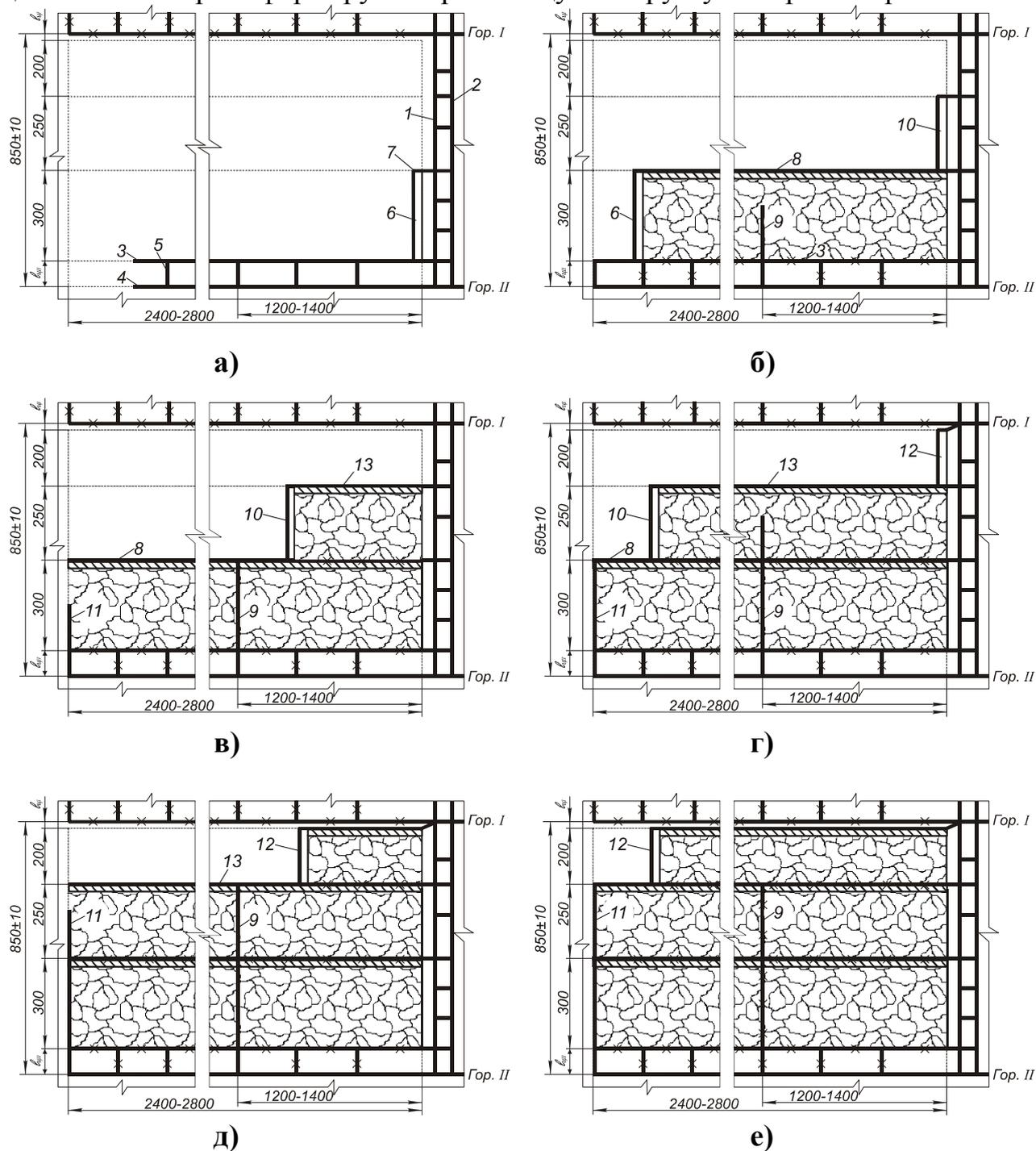
Рисунок 9. Этапы развития подготовительных и очистных работ при восходящем порядке отработки ярусов в панели на большой глубине: **а** – первоначальный при проведении основного штрека; **б** – при отработке первого столба и проведении первого промежуточного бремсберга по выработанному пространству; **в, г, д и е** – при отработке последующих столбов с проведением промежуточных бремсбергов по выработанному пространству и фланговых по длине последующих лав
