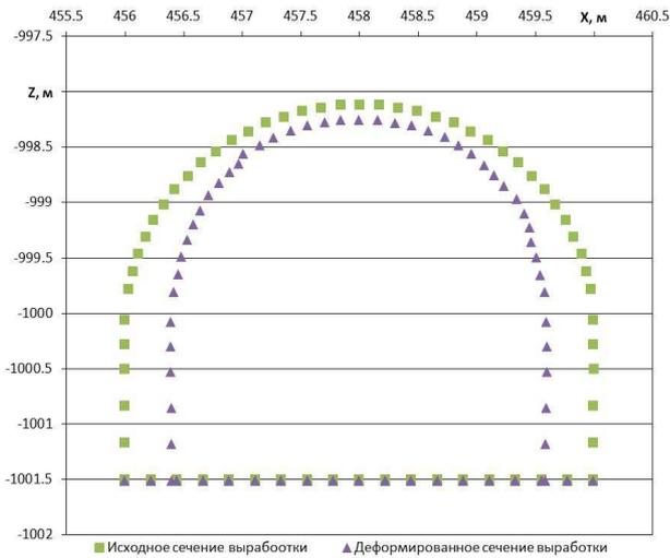
Рисунок 4. Изменения обнаженного выработкой породного контура после ее сооружения (X и Z – координаты узлов выработки в модели)
