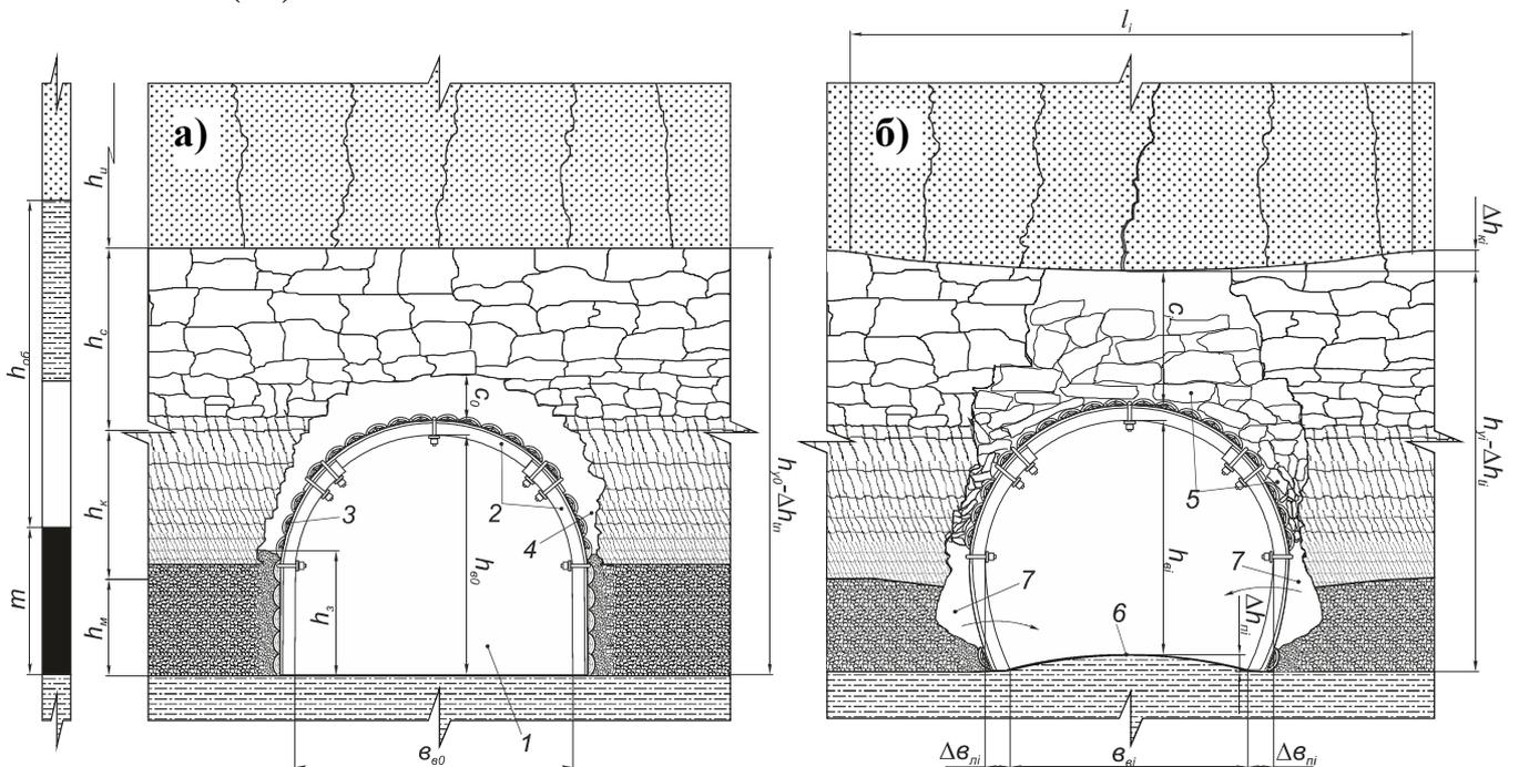
Рисунок 8. Схемы формирования ожидаемых смещений контуров выработки, пройденной в уплотненных породах выработанного пространства: а и б – соответственно исходная при проведении и конечная после затухания процесса сдвижения
