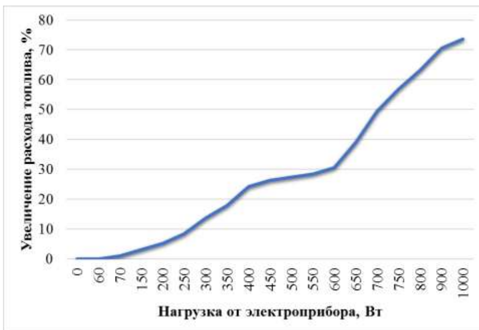
Рисунок 6 — Зависимость увеличения расхода топлива от нагрузки электроприбора
