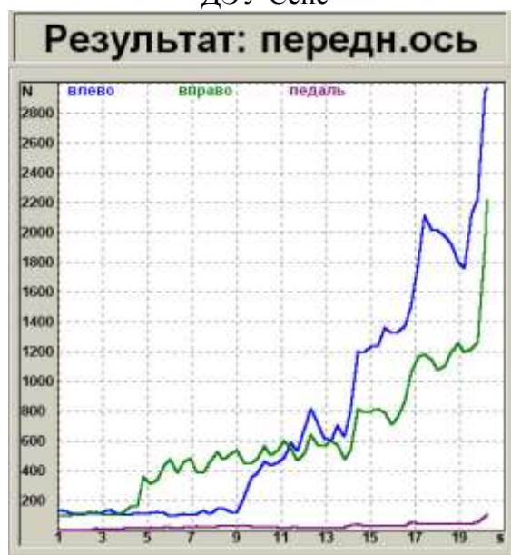
Рисунок 1 — Протокол испытаний параметров тормозных качеств автомобиля ДЭУ Сенс
