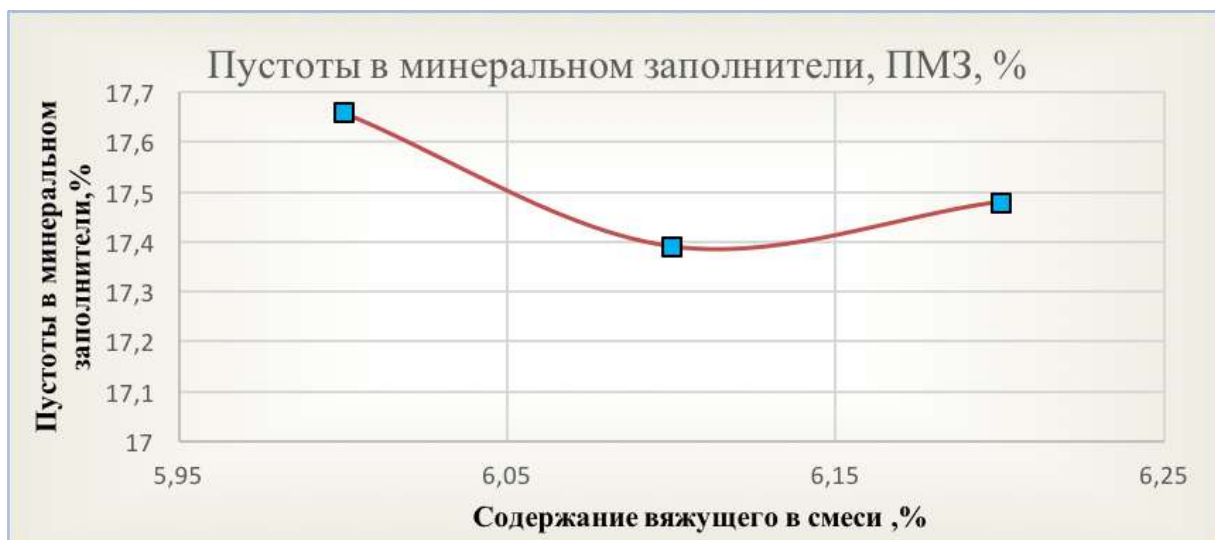
Рисунок 2 — Пустоты в минеральном заполнителе щебеночно-мастичного асфальтобетона SMA-19, %
