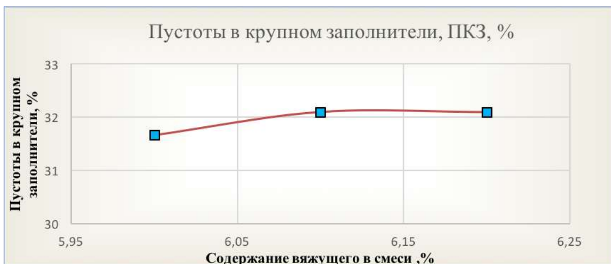
Рисунок 3 — Пустоты в крупном заполнителе щебеночно-мастичного асфальтобетона SMA-19, %
