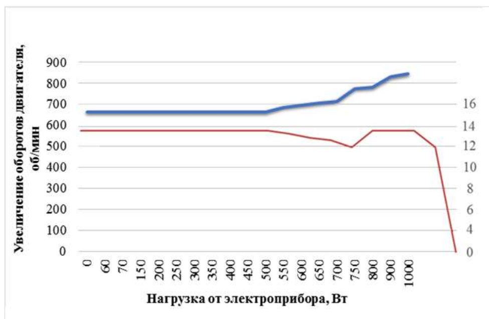
Рисунок 7 — Зависимость оборотов двигателя от нагрузки электроприбора
