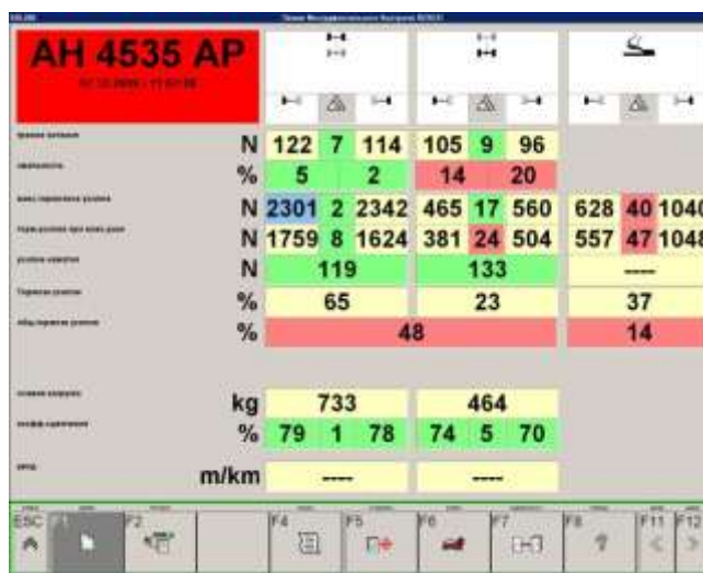
Рисунок 1 — Протокол испытаний параметров тормозных качеств автомобиля ДЭУ Сенс
